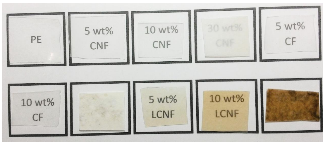
Figura 5.2 – Aspecto visual dos filmes de PE/NFC, PE/FC e PE/NFLC, após prensagem à 100 °C.
