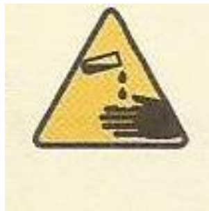
FIGURA 2.5 – Símbolo indicando propriedade química da substância, substância corrosiva.
