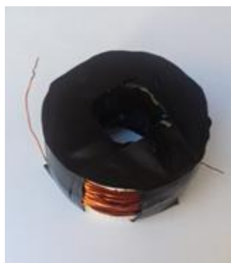
Figura 4.3. Bobina circular construída para o experimento com fio de cobre. A bobina está envolvida com fita isolante para segurar o fio enrolado.
