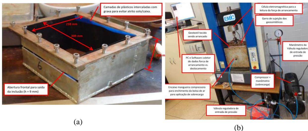
Figura 2.23. a) Dimensões da caixa de pequeno porte para ensaios de arrancamento, b) Equipamentos para ensaio de arrancamento de pequeno porte. (DA SILVA, 2016).
