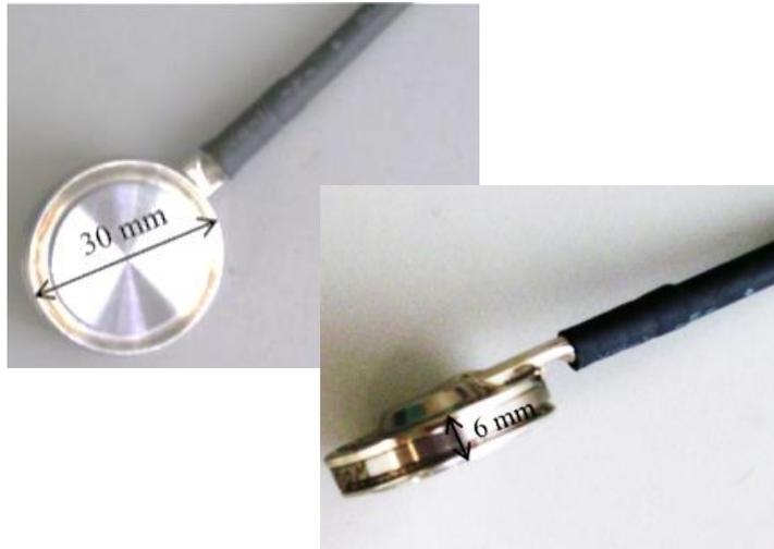
Figura 3.11. Célula de tensão total, de 30 mm de diâmetro e 6 mm de espessura. Nota: Ambas células possuem as mesmas características físicas.
