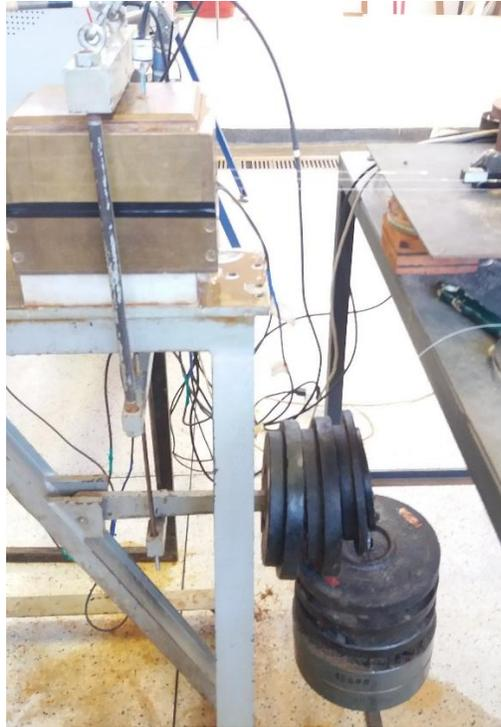
Figura 3.23. Sistema de aplicação da tensão confinante, mediante um sistema de pesos e alavancas para ensaios de arrancamento de pequeno porte.
