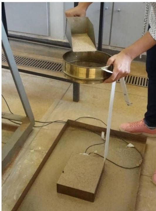
Figura 3.22. Técnica de chuva de areia para colocar a areia seca dentro da caixa de ensaios de arrancamento de pequeno porte.
