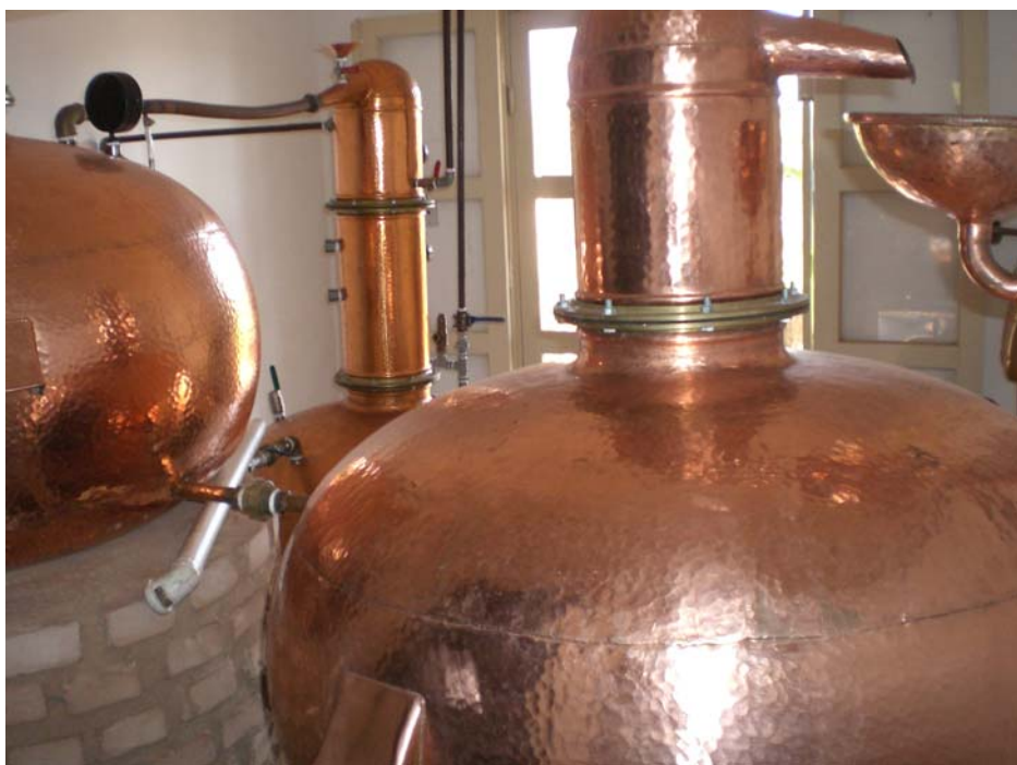
Figura 4: alambique de cobre no qual é feita a cachaça orgânica.
