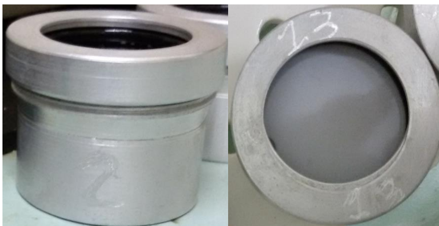
FIGURA 3.26 – Copo de Payne contendo a membrana polimérica selada.
