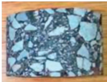
Figura 4 – Concreto asfáltico usinado a quente Fonte: Bernucci, et al. (2006)
