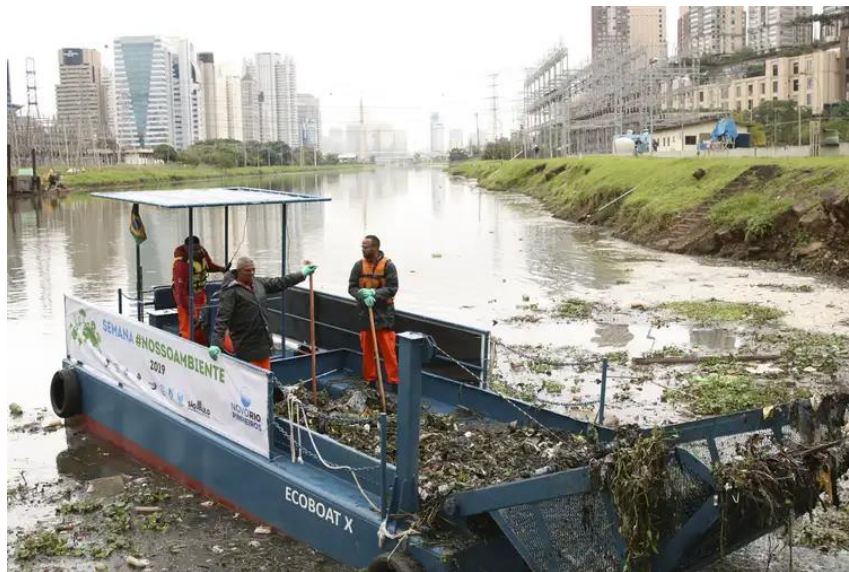
Figura 8: Embarcações adaptadas para a retirada de resíduos do Rio Pinheiros
