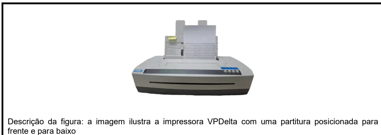
Figura 6: Posicionamento do papel na impressora braille
