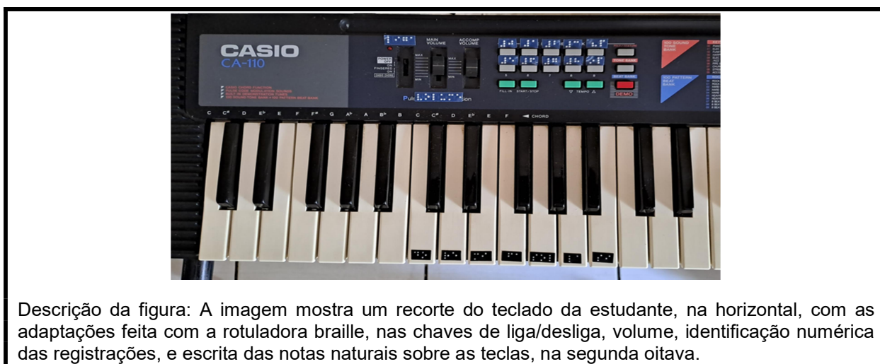
Figura 34: Adaptação de Teclado da Estudante
