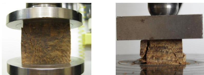
Figura 33 - Modos de falha do bamboo scrimber sob compressão perpendicular às fibras
