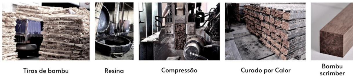
Figura 31 - Processo geral de fabricação do bamboo scrimber
