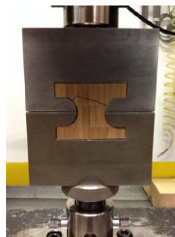
Figura 15 - Modos de falha do LBL sob tração perpendicular às fibras
