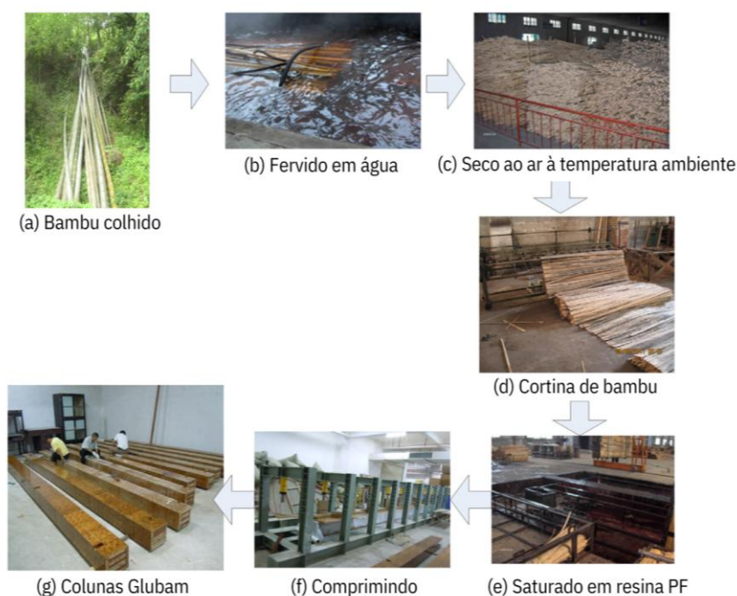
Figura 23 – Novo processo de fabricação do glubam
