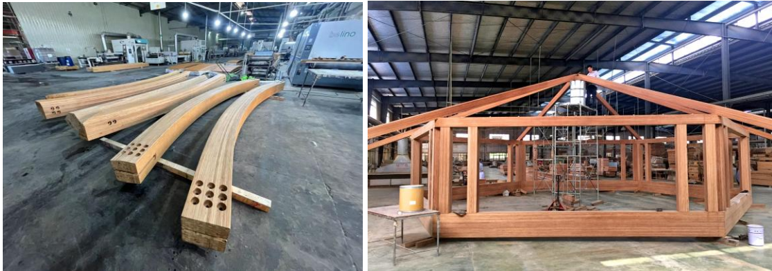
Figura 69 – Vigas de bambu engenheirado estrutural
