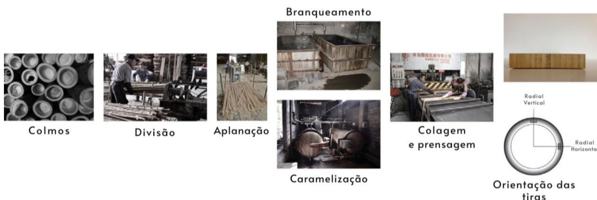
Figura 13 – Processo de fabricação do bambu laminado
