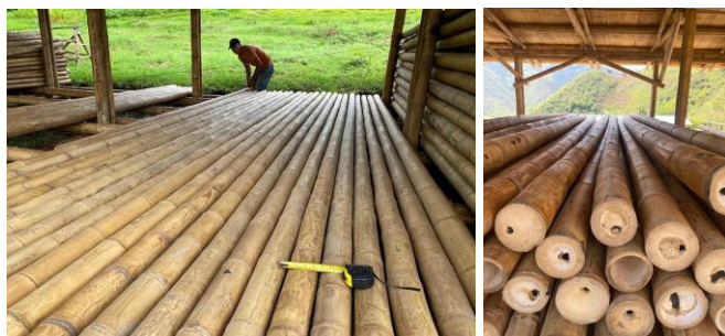
Figura 81 - ReNüTeq Columbia SA - Secagem de colmos
