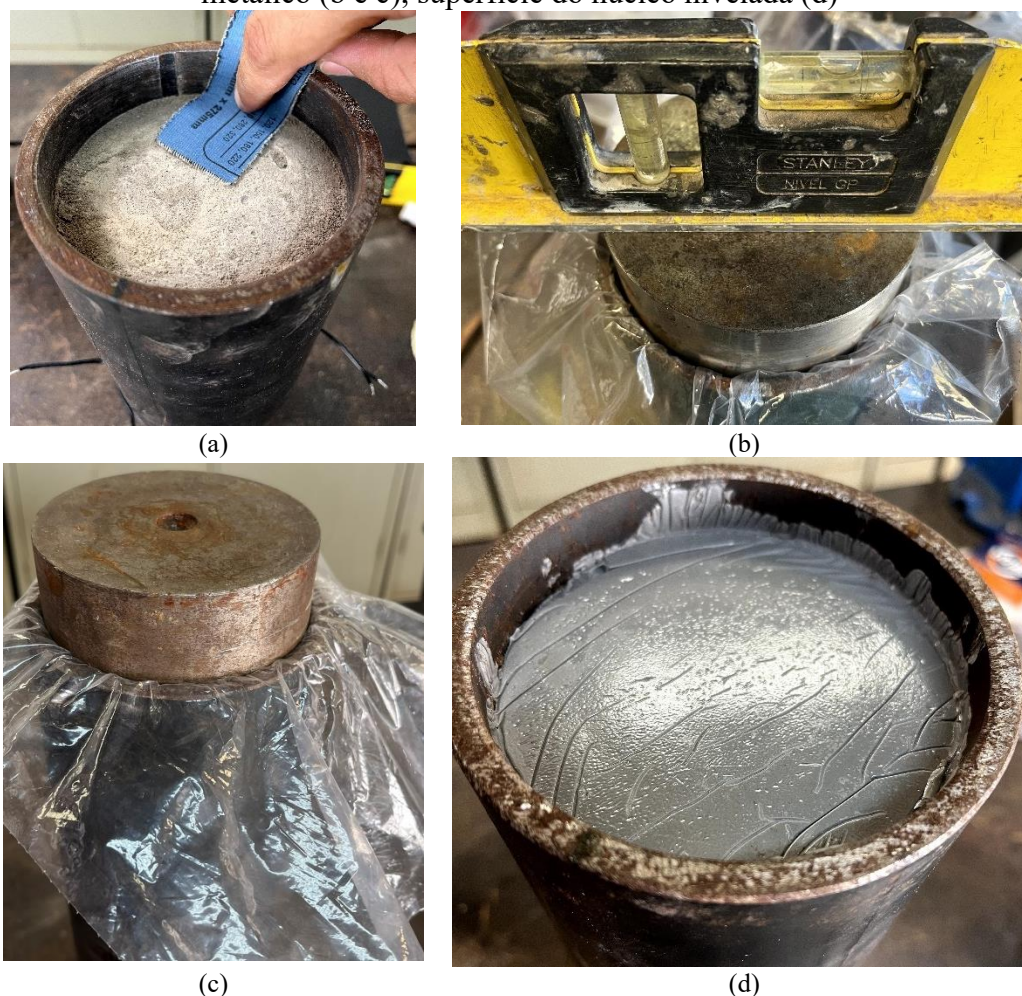
Figura 4.34 – Lixamento do núcleo (a), aplicação do composto e nivelamento do cilindro metálico (b e c), superfície do núcleo nivelada (d)
