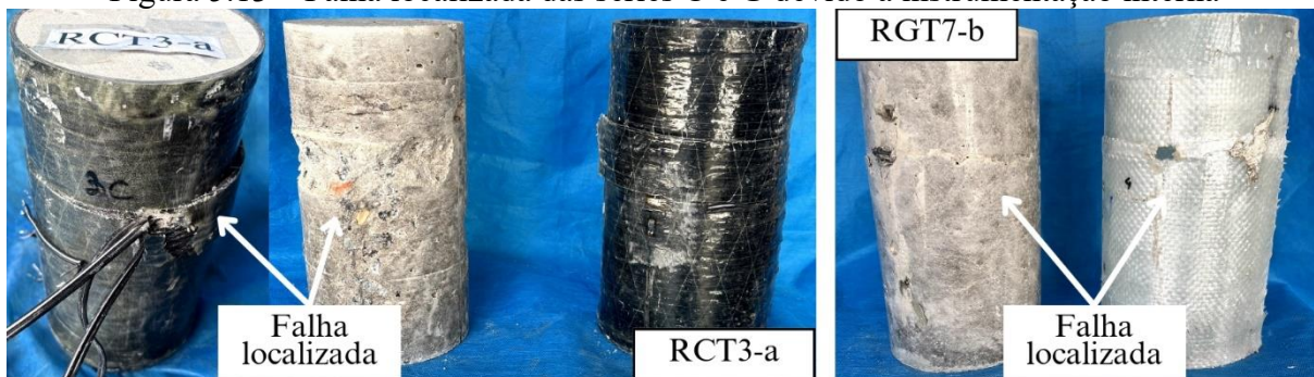
Figura 5.13 – Falha localizada das séries C e G devido à instrumentação interna
