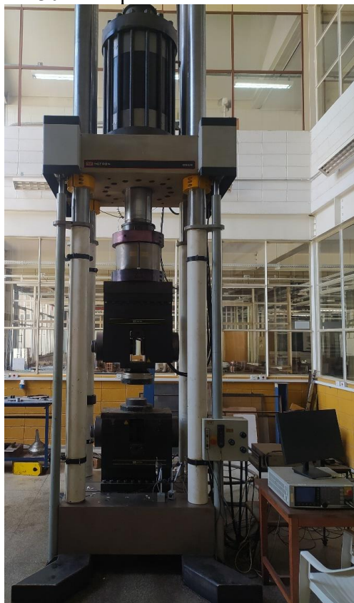
Figura 4.30 – Máquina universal servo-hidráulica
