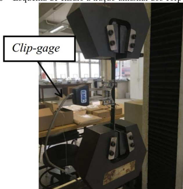
Figura 4.10 – Esquema de ensaio à tração uniaxial dos corpos de prova de FRP
