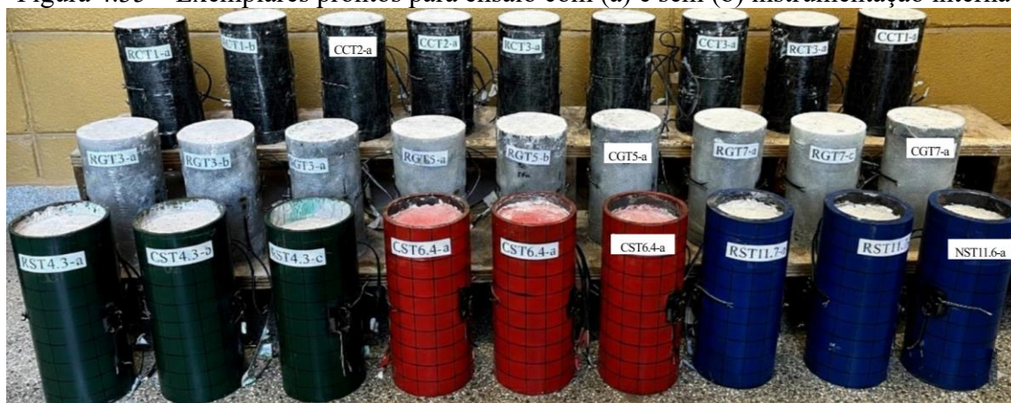
Figura 4.35 – Exemplos prontos para ensaio com (a) e sem (b) instrumentação interna
