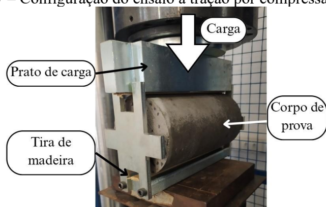
Figura 4.17 – Configuração do ensaio à tração por compressão diametral
