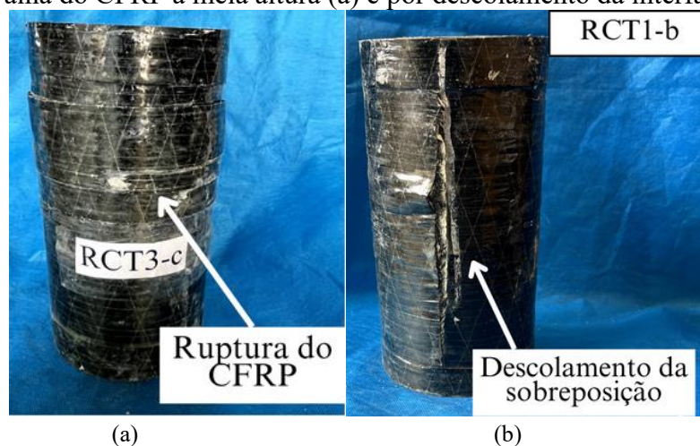
Figura 5.14 – Falha do CFRP à meia altura (a) e por descolamento da interface (b) da série C
