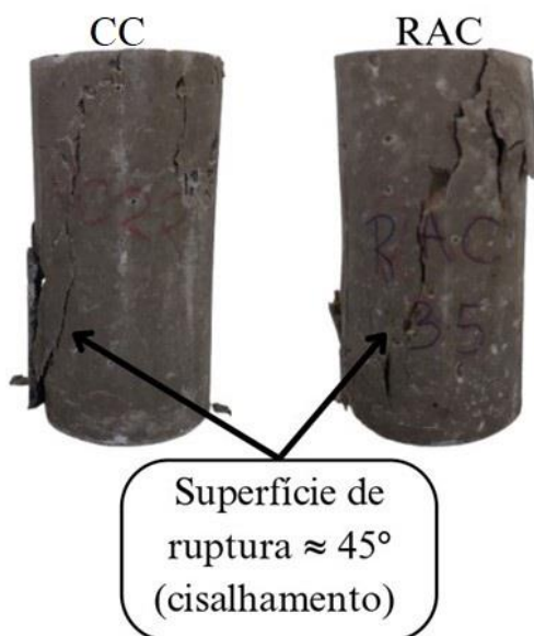
Figura 4.16 – Modo de falha do concreto à compressão axial
