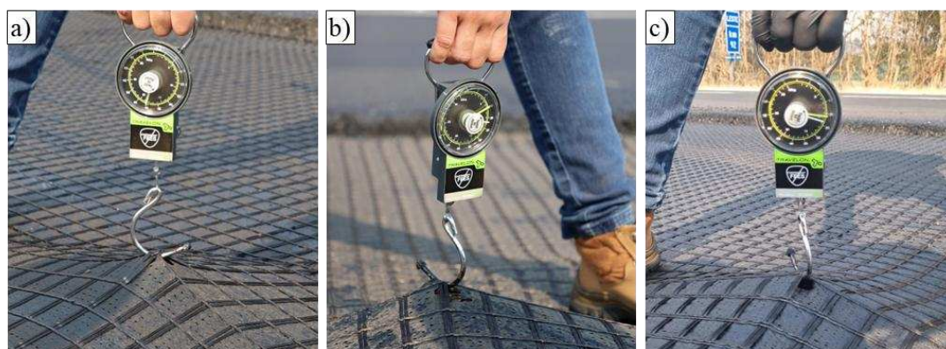
Figura 3.20 – Ensaio de aderência de campo pull-upfield: a) G-PET; b) G-PVA; c) G-FV (Autora, 2026).
