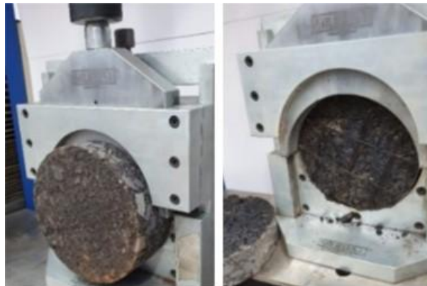
Figura 2.23 – Dispositivo Leutner para ensaio de cisalhamento de interface (Urquiza Jr., Silva e Correia, 2022).
