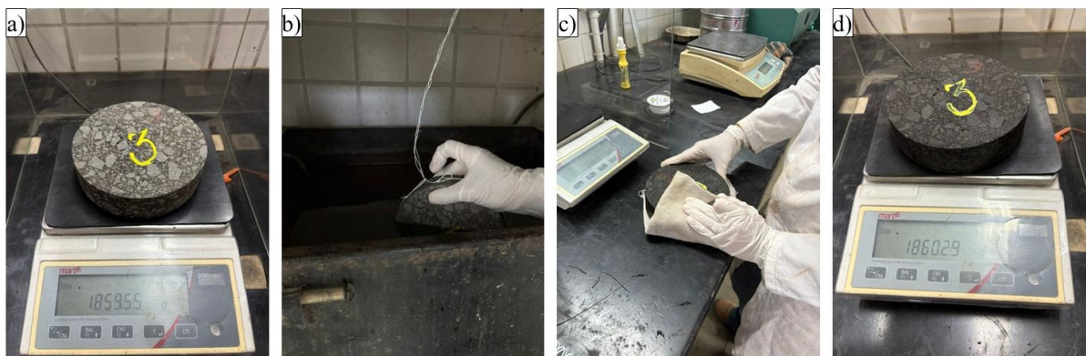
Figura 3.28 – Ensaio de densidade aparente: a) pesagem do corpo de prova ao ar; b) imersão do corpo de prova em água; c) secagem da superfície com o pano umedecido; d) pesagem do corpo de prova na condição saturada superfície seca (Autora, 2026).
