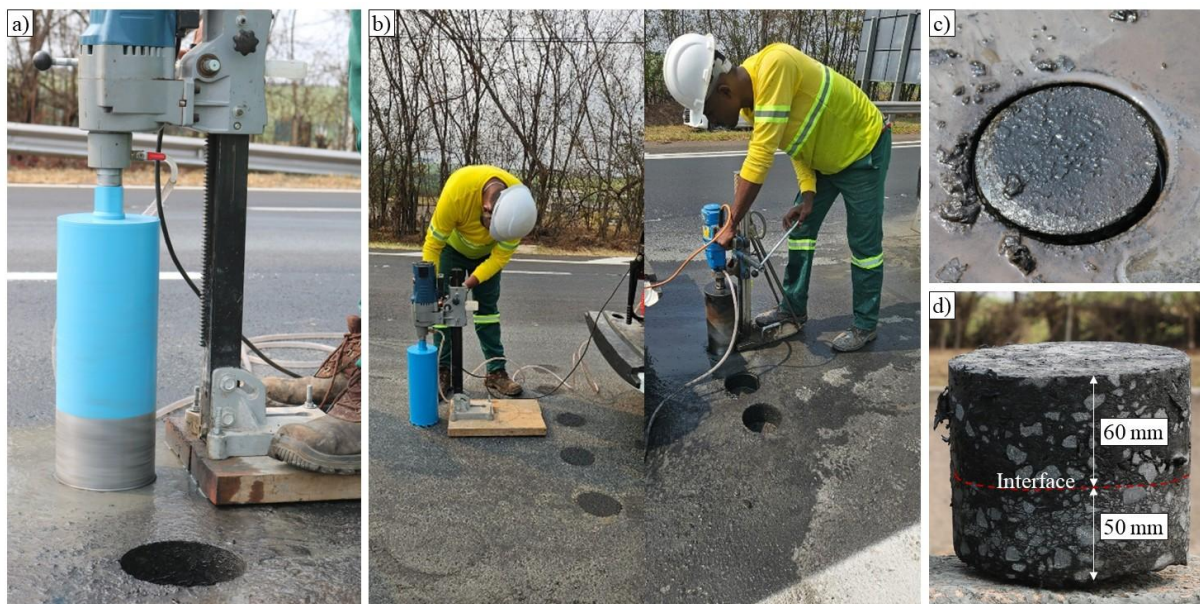
Figura 3.24 – Extração corpos de prova cilíndricos: a) perfuratriz; b) processo de extração; c) corte do corpo de prova na superfície; c) corpo de prova extraído (Autora, 2026).
