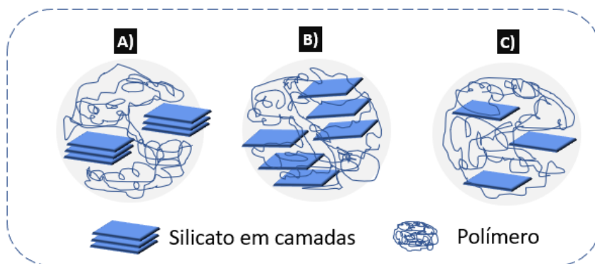
FIGURA 5.11 – Esquema ilustrativo das possibilidades de arranjo do polímero e argila. Fonte: Adaptado de ALEXANDRE et al.,2009.
