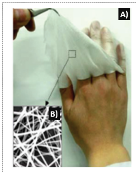
FIGURA 1.4 – a) Imagem da manta de fibras de PLA; b) imagem de microscopia eletrônica de varredura das fibras do PLA. Fonte: XU et al 2015.
