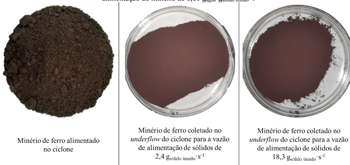
Figura 84 – Fotografias do minério de ferro alimentado no ciclone e do minério coletado no underflow do ciclone. Temperatura do ar de 80 °C. Velocidade superficial de alimentação do ar de 20 m·s -1 . Número de compartimentos do alimentador: 5. Vazão de alimentação de sólidos de 2,4 e 18,3 g sólido úmido ·s -1 . Umidade de alimentação do minério de 0,10 g água ·g sólido úmido -1 .
