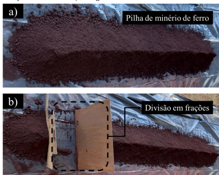
Figura 6 – a) Fotografias da pilha de minério de ferro pellet feed , in natura do Lote B utilizadas para a amostragem e homogeneização do material. b) Fotografia da divisão do lote de minério em frações.
