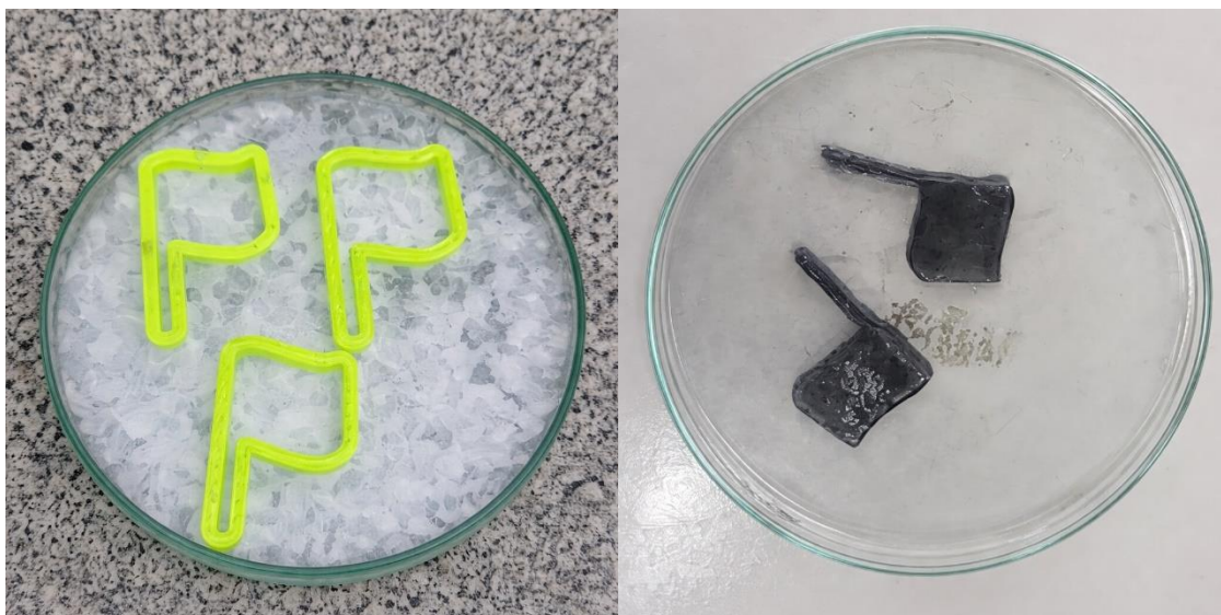
FIGURA 3.3.2— Hidrogéis reticulados fisicamente após moldagem e corte.
