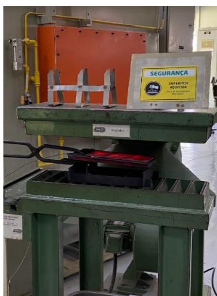
Figura 31. Soprador utilizado no resfriamento ao ar forçado.
