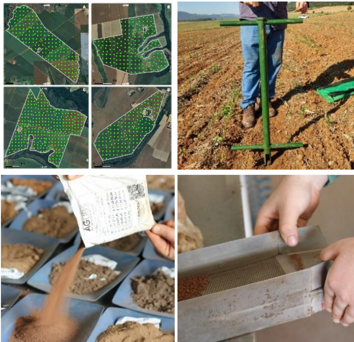
Figura 7 – Sequência de imagens que exhibe o planejamento experimental, a coleta de solo, secagem e moagem.
