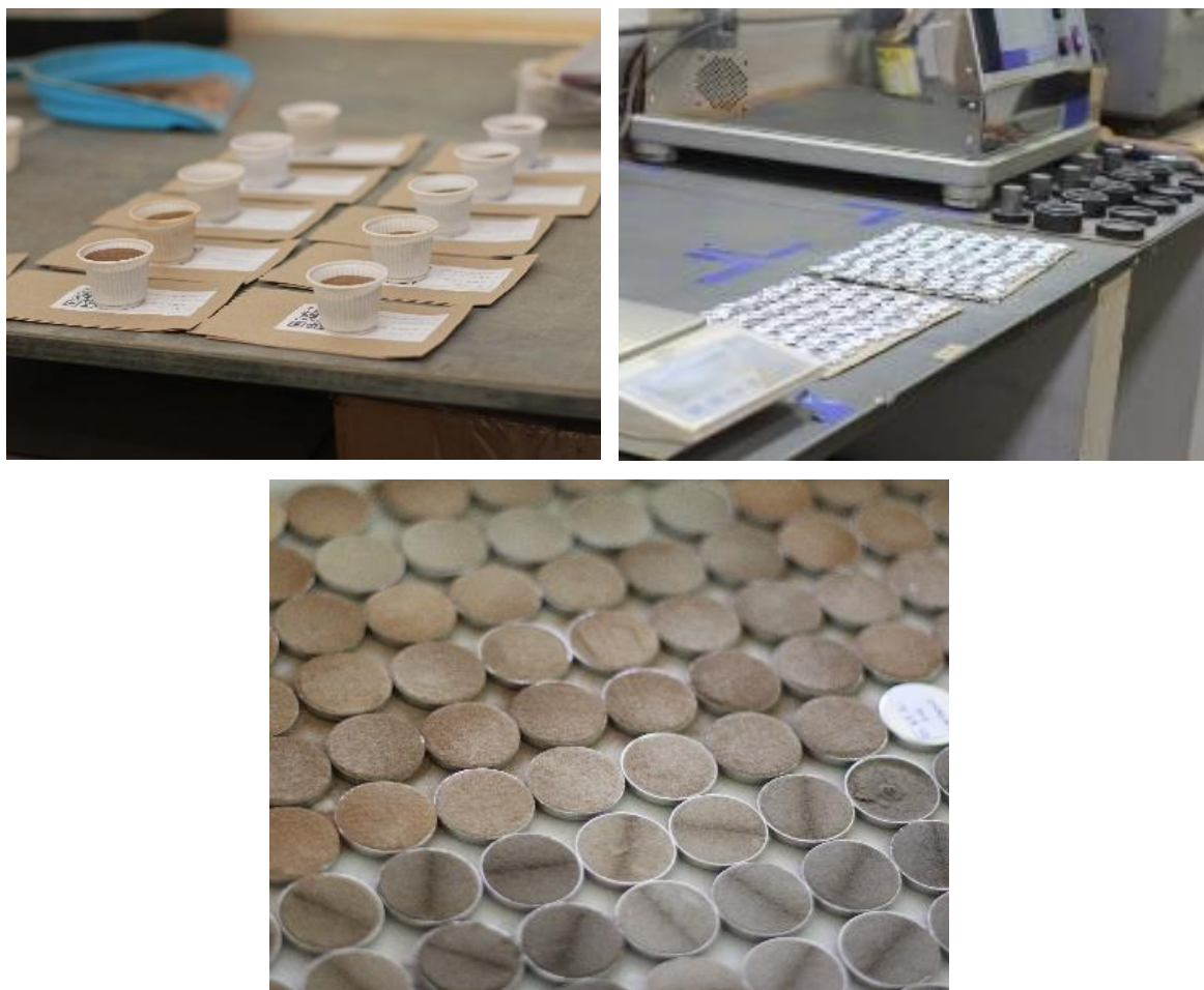
Figura 9 – Sequência de imagens da pesagem, preparação e pós prensagem das amostras LIBS.
