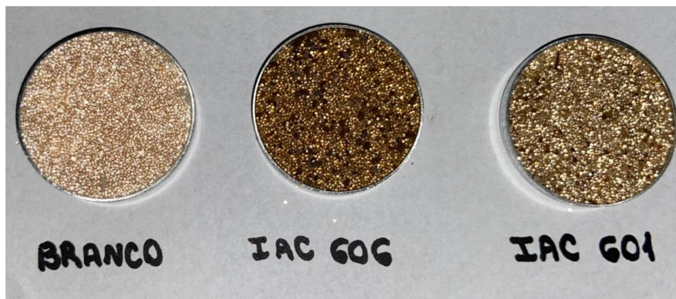
Figura 15 – Amostras para medida em AGLIBS confeccionadas a partir de resina aniônica.
