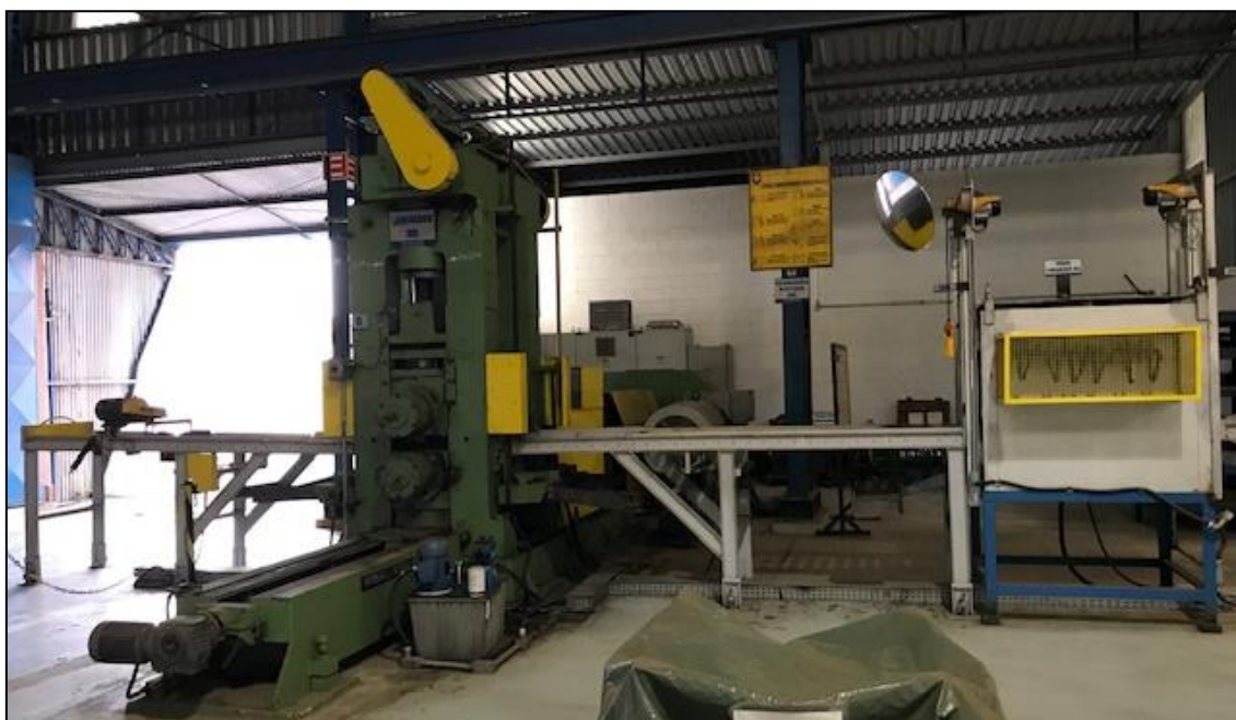
Figura 4.7 - Laminador do Centro de Pesquisa e Desenvolvimento - Villares Metals.
