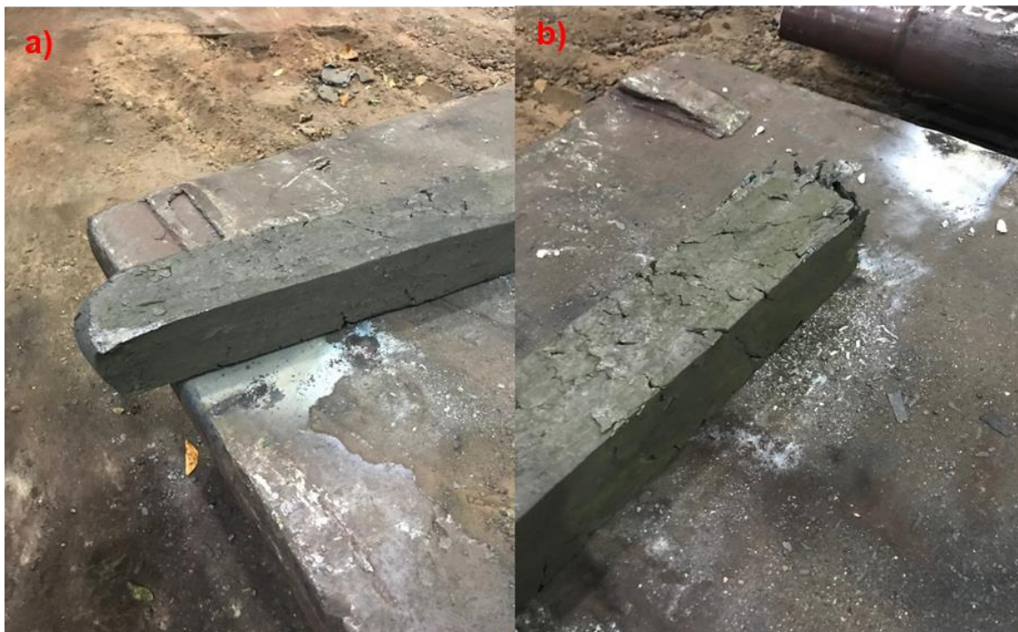
Figura 5.16 - Rompimentos observados na barra forjada: a) Região do pé e b) Região da cabeça. Corrida 1107315.
