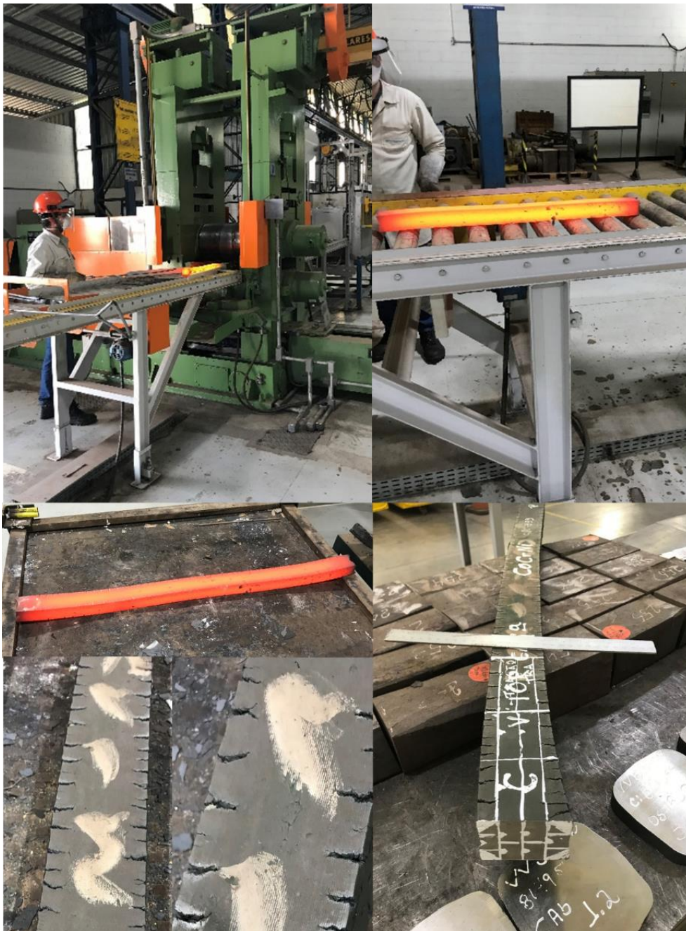
Figura 5.21 - Conformação por laminação a quente da corrida 1107333. a) e b) Laminação a quente; b) Resfriamento da barra logo após térmico da laminação; d) e e) Detalhamento dos rompimentos de canto; f) Esquema de marcação de amostras para realização dos ensaios mecânicos e metalográficos.
