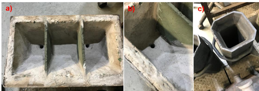
Figura 4.4 - a) Tundish de dois compartimentos, b) Detalhamento das aberturas laterais e na base para escoamento do metal líquido e c) Lingoteira de ferro fundido com seção quadrada de 72 mm de lado.
