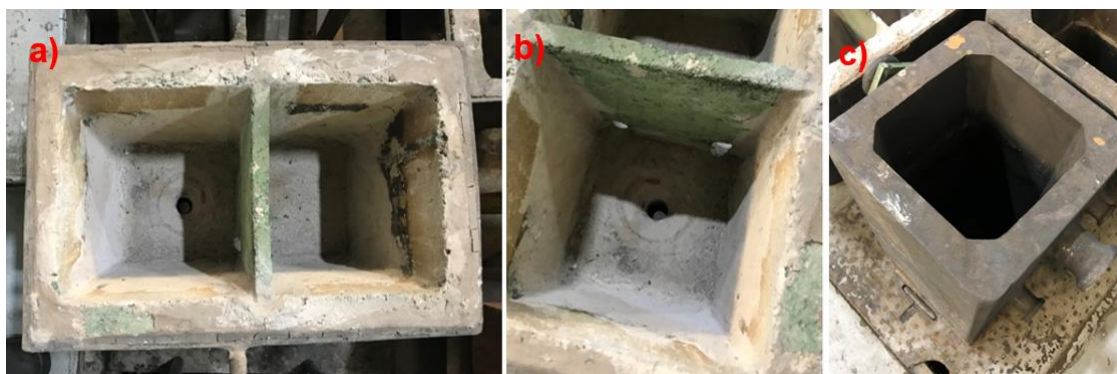
Figura 4.3 - a) Tundish de dois compartimentos, b) Detalhamento das aberturas laterais e na base para escoamento do metal líquido e c) Lingoteira de ferro fundido com seção quadrada de 145 mm de lado.
