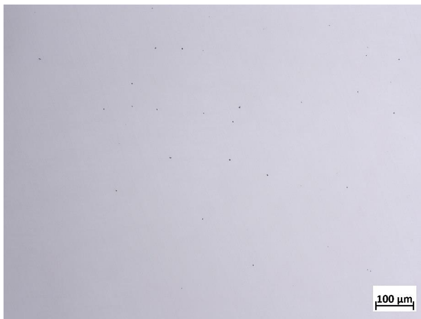
Figura 5.7 - Micrografia típica das microinclusões encontradas para a corrida 1107315.
