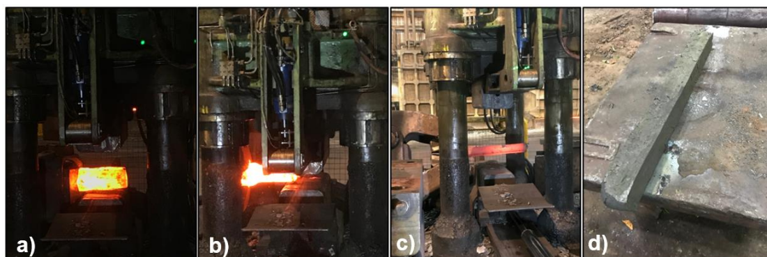
Figura 4.6 - Processo de forjamento, a) Início de forjamento, com fixação da parte da cabeça do lingote no manipulador (a esquerda) e início de forjamento da região pé/meio, b) detalhamento do forjamento até aproximadamente o meio do comprimento do lingote, c) forjamento da região meio/cabeça, com lingote já rotacionado, com porção do pé fixada no manipulador e d) barra final obtida após forjamento.
