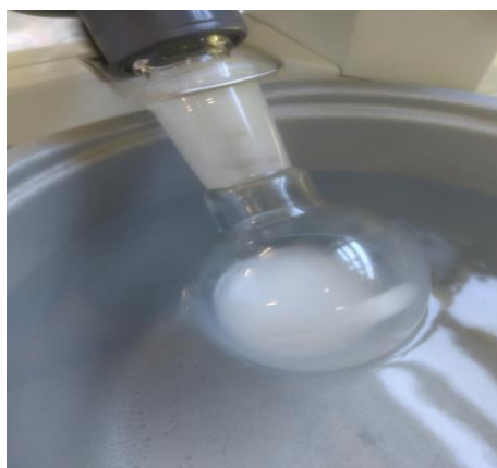
FIGURA 38 - Foto da substância isolada P7, sendo evaporada pelo evaporador rotativo, mostrando a formação de um precipitado branco, aparentando um pó fino.
