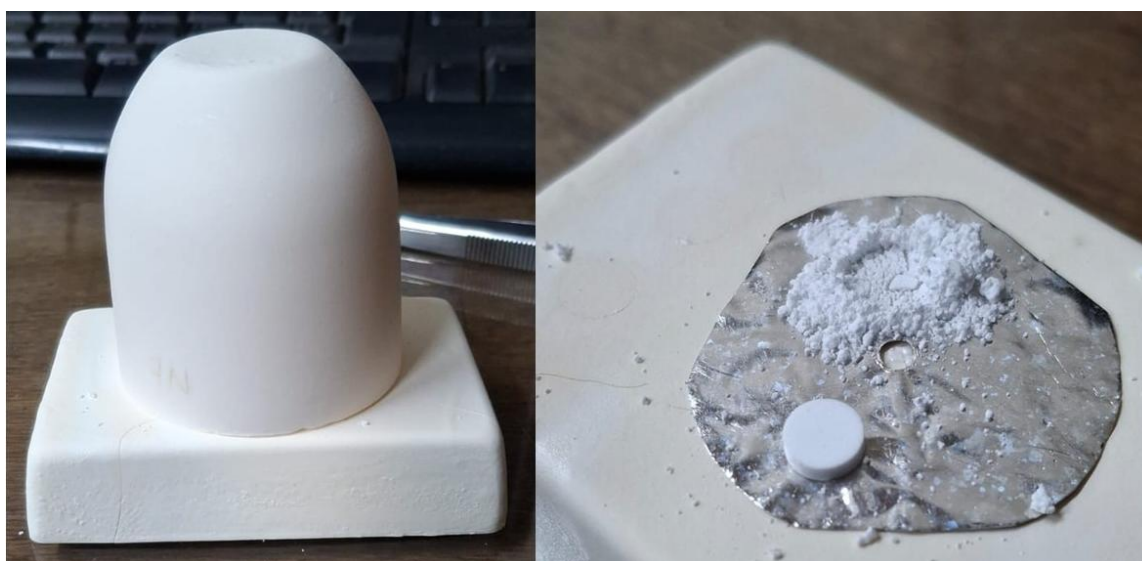
Figura 5.6 – Esquema utilizado para a sinterização com pó de sacrifício.
