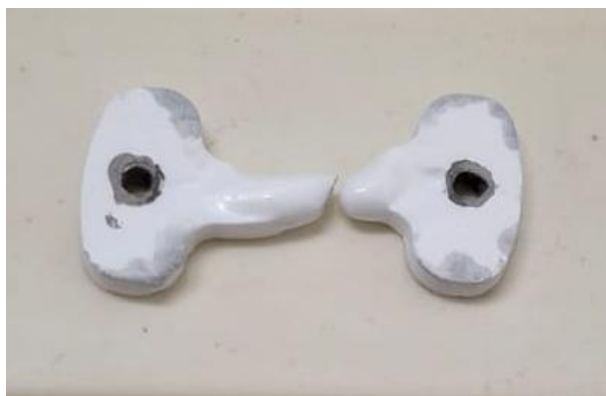
Figura 5.13 – Amostra de NZSP após resfriamento rápido submetida a potência de 175 \text{ mW mm}^{-3} .
