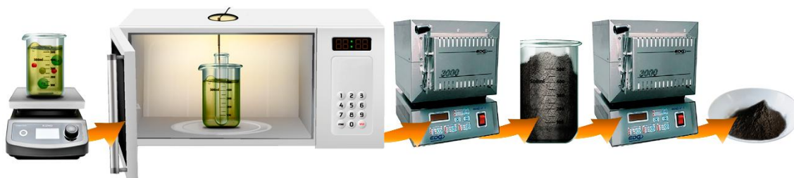
Figura 3.2 – Representação da síntese one-pot pelo método Pechini assistido por micro-ondas dos nanopós do compósito bifásico (1-x)\text{BaZr}_{0,08}\text{Ti}_{0,92}\text{O}_3/(x)\text{CoFe}_2\text{O}_4 ( 0,00 \leq x \leq 1,00 ). Fonte: Adaptado de [12], [13].
