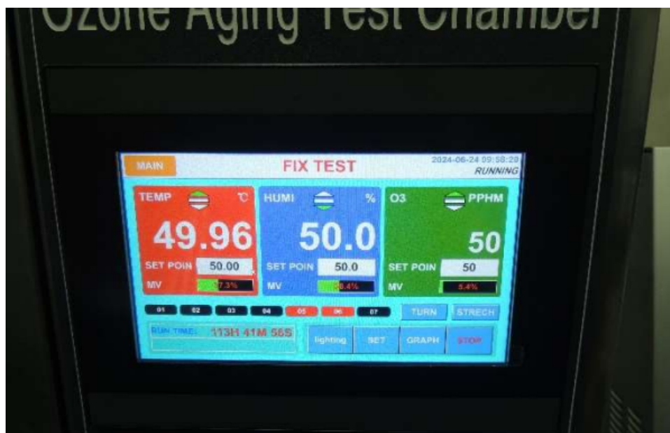
Figura 9. Foto do painel da câmara de ozônio durante ensaio com parâmetros controlados.
