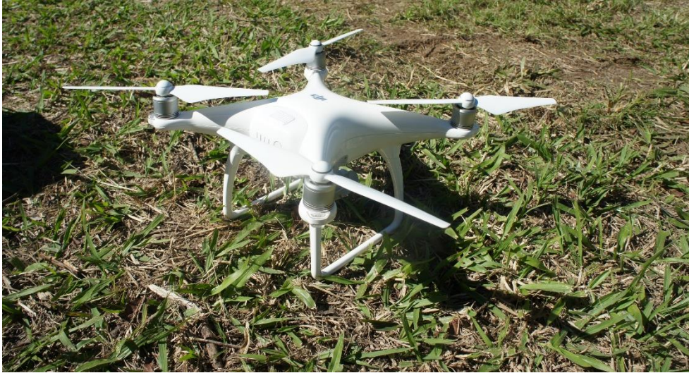
Figura 6 - UAV Phantom® 4 com câmera digital (RGB) acoplada, utilizado para a captação das imagens.
