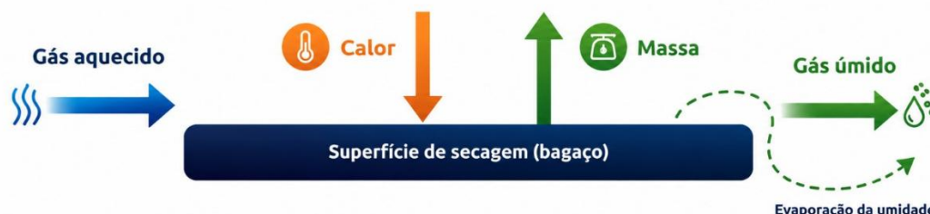
Figura 4: Ilustração esquemática de um processo de secagem convencional.
