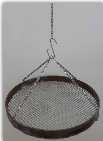
Figura 5 – Suporte utilizado para suspender a placa de Petri dentro da estufa.
