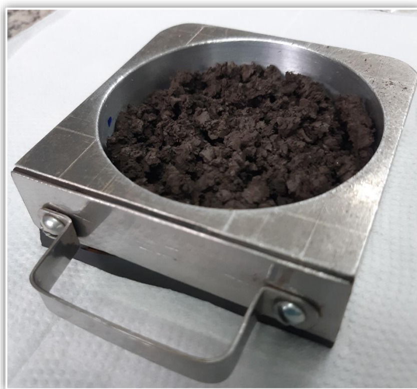
Figura 75 – Gaveta de secagem do leito fixo II com a camada fina de material úmido a 0,33 b.s. (25% b.u.).
