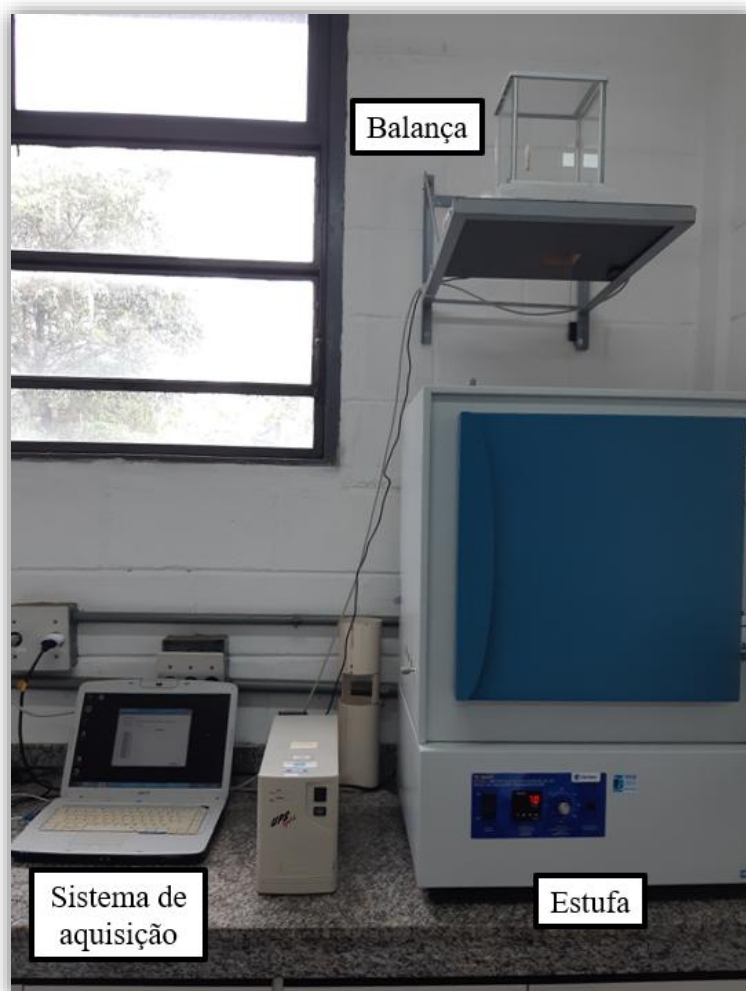
Figura 4 – Aparato experimental para a secagem em estufa.
