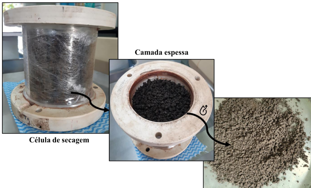
Figura 64 – Célula de secagem utilizada em leito fixo, disposição do material úmido a 0,33 b.s. (25% b.u.) em camada espessa e sua aparência após o processo.
