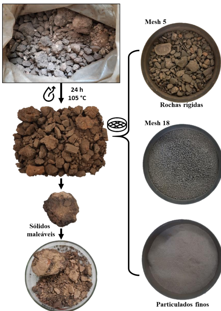
Figura 2 – Minério de manganês fornecido pelo Instituto Tecnológico Vale (ITV), da mina Azul em Carajás, Estado do Pará, Brasil. No material, havia sólidos macios, rochas duras e particulados finos. Para sua preparação, o minério foi previamente seco em estufa a 105 °C por 24 horas. Em seguida, foi separado em peneiras Tyler, utilizando malhas de 5 (4,0 mm) e 18 (1,0 mm).
