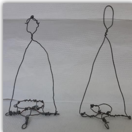
Figura 8 – Suporte utilizado para suspender o pellet esférico dentro da estufa.
