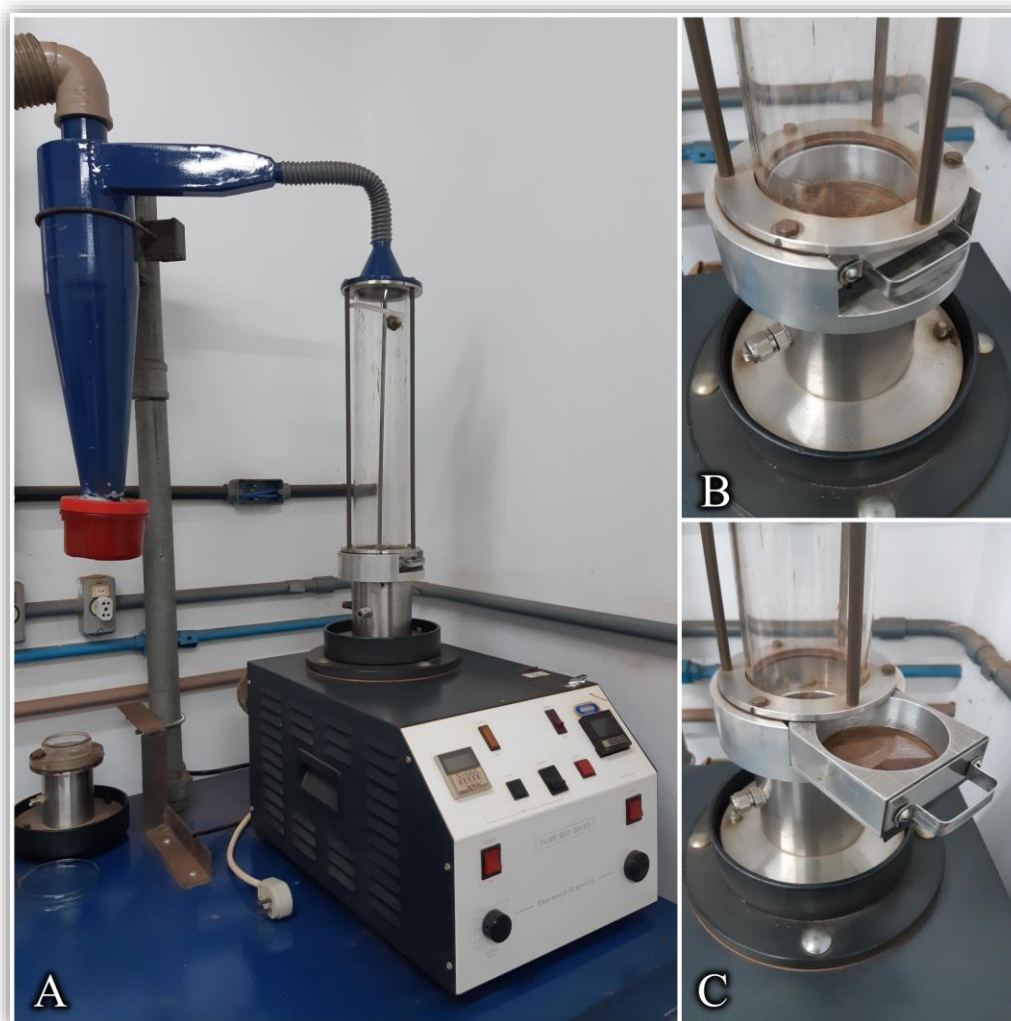
Figura 12 – A) Unidade experimental de secagem em leito fixo (II). B) Gaveta de secagem fechada. C) Gaveta de secagem aberta
