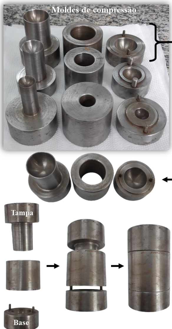
Figura 7 – Moldes de compressão utilizados para a formação de pellets esféricos com diâmetros de 1,40, 2,10 e 2,70 ± 0,05 cm.
