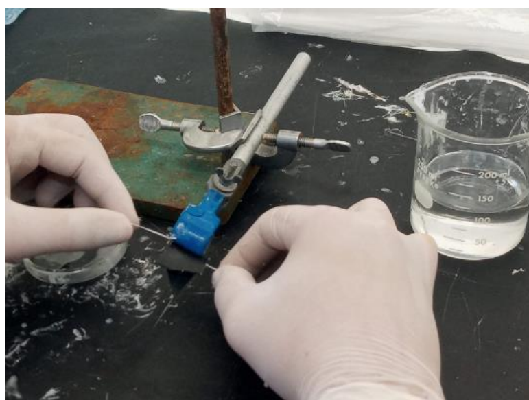
Figura 5.11 - Fabricação de feixe de vidro bioativo por meio de aplicação manual de solução de PCL.
