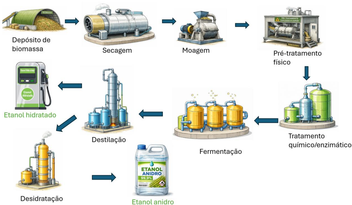
Figura 3.6- Etapas para a produção do etanol 2G.
