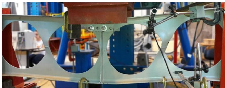
(a) Instabilidade no montante de alma por cisalhamento (FMAV)
