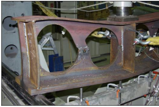
(b) ruptura da solda por FMAv
