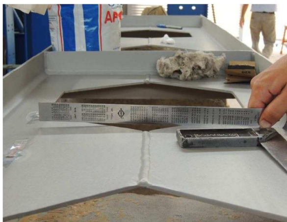
Figura 4.5 - Imperfeição geométrica em viga castelada
