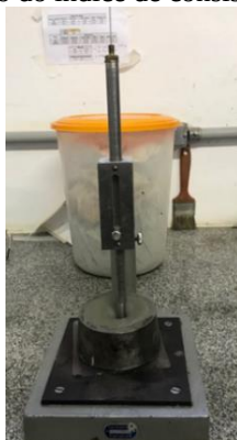
Figura 37 – Determinação do índice de consistência da pasta referência.
