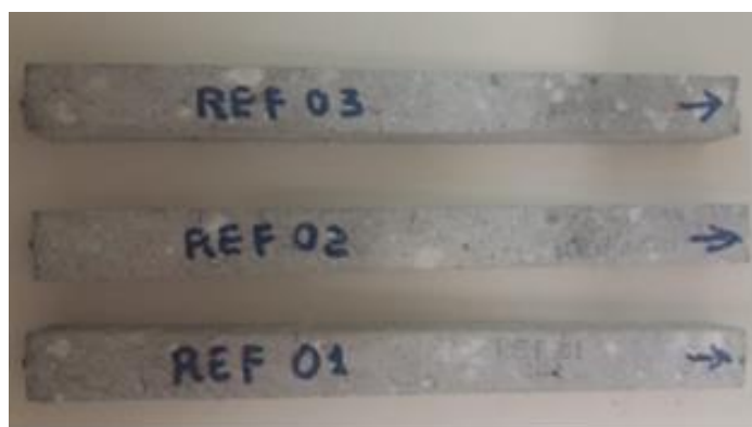
Figura 48 – Corpos de prova prismáticos para o ensaio de RAS.
