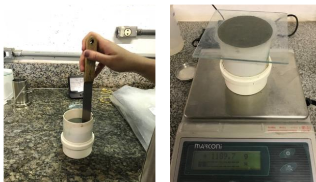
Figura 44 – Ensaio de densidade de massa e teor de ar incorporado.
