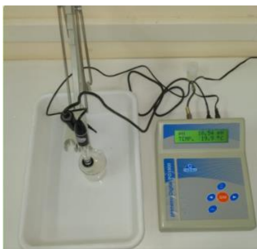
Figura 27 – Ensaio de potencial hidrogeniônico.
