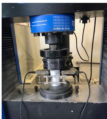
Figura 46 – Ensaio de módulo de elasticidade estático.
