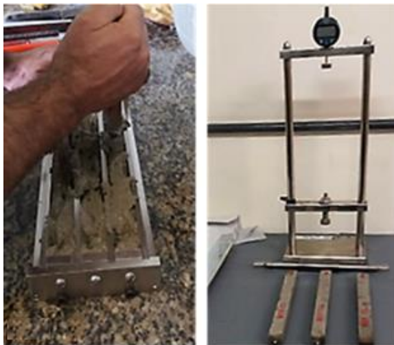
Figura 49 – Moldagem dos corpos de prova para o ensaio de RAS e relógio comparador para medida da variação dimensional dos corpos de prova.
