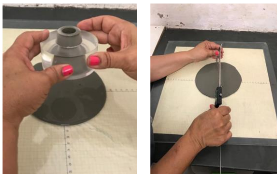
Figura 36 – Realização do ensaio do miniabatimento e medição dos diâmetros de abertura da pasta.
