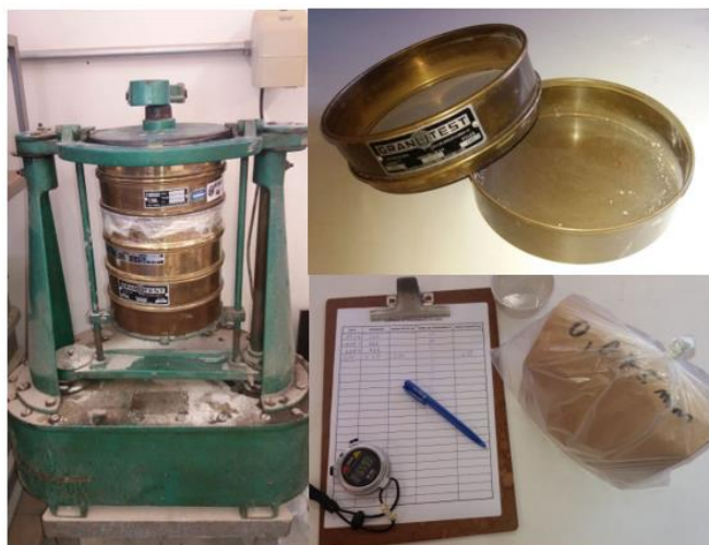
Figura 24 – Processo de peneiramento e armazenagem do pó de vidro.
