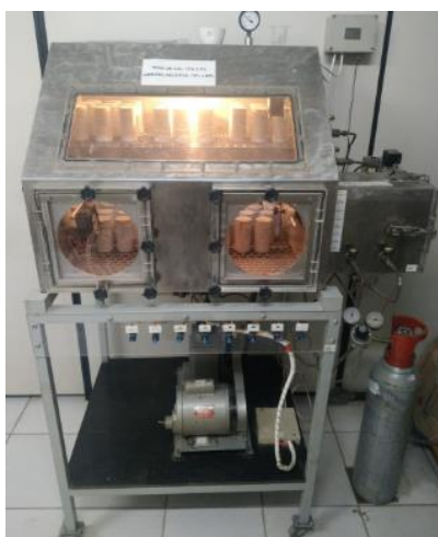
Figura 50 – Câmara utilizada para acelerar o processo de carbonatação dos corpos de prova.
