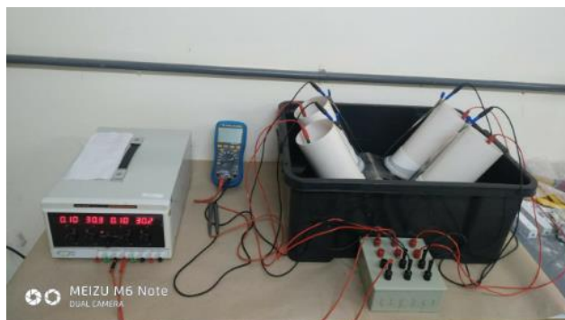
Figura 59 – Ensaio de migração de cloretos no estado não estacionário em andamento.
