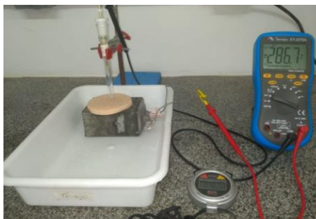
Figura 66 – Célula eletroquímica para a medida do potencial de corrosão das barras com a colocação da esponja para umedecimento superficial, medida do potencial de corrosão da armadura no compósito cimentício, utilizando uma esponja umedecida como contato.
