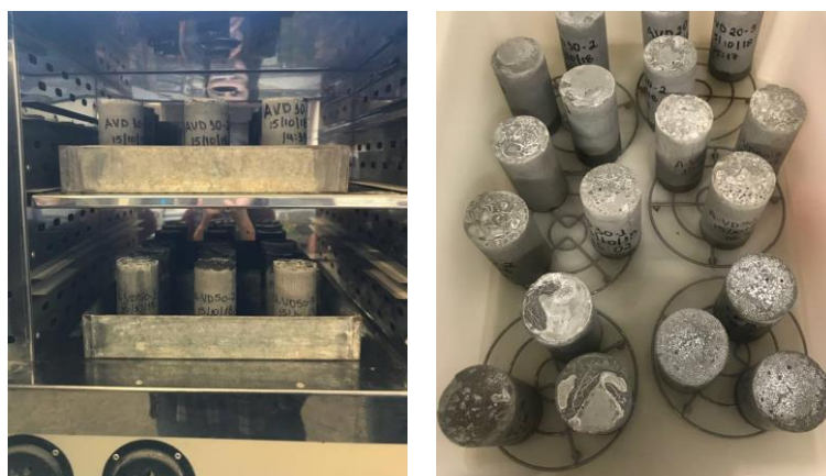
Figura 45 – Corpos de prova em estufa até constância de massa e corpos de prova em recipientes com água no ensaio de absorção de água.
