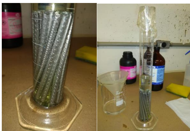
Figura 64 – Barras em solução de ácido clorídrico 1:1 com 3,5 g/l de hexametenotetramina.
