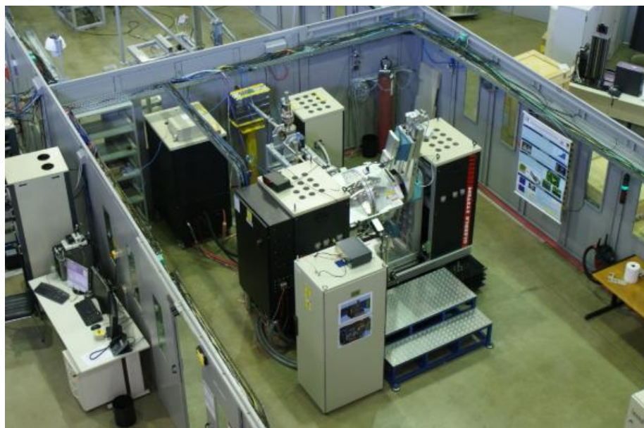
Figura 68 – Equipamento utilizado no ensaio de tomografia computadorizada de raios X.
