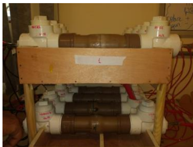
Figura 53 – Realização do ensaio de migração de cloretos.
