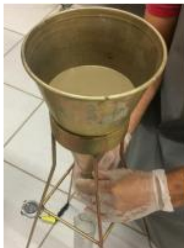
Figura 35 – Ensaio do cone de Marsh.
