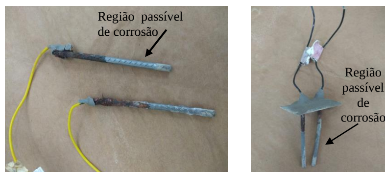
Figura 105 – Barras de aço inseridas nos corpos de prova após ensaio de potencial de corrosão.
