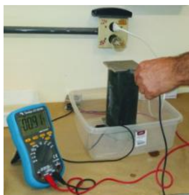
Figura 62 – Ensaio de resistividade elétrica volumétrica em andamento.
