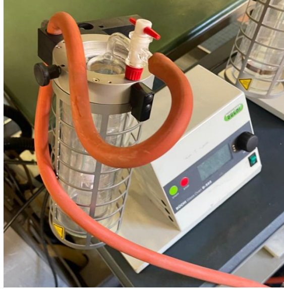
FIGURA 4.6 – Esquema do sistema de secagem a vácuo Büchi® com controle de temperatura para os componentes das baterias (Do autor).
