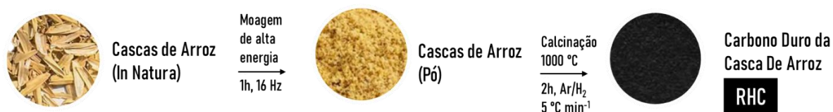
FIGURA 4.1 – Esquema ilustrativo do processo de síntese do carbono duro da casca de arroz (Do autor).
