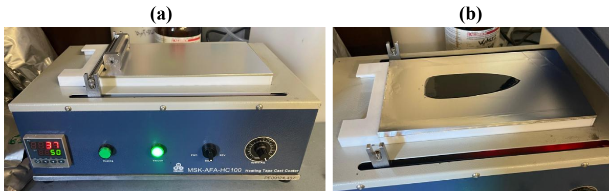
FIGURA 4.5 – Esquema de obtenção dos eletrodos em folha de alumínio: (a) antes e (b) depois da deposição da suspensão (Do autor).
