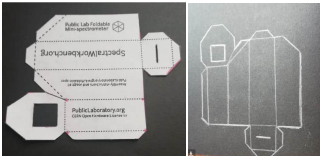
Figura 28 - Molde para construção do espectrógrafo.
