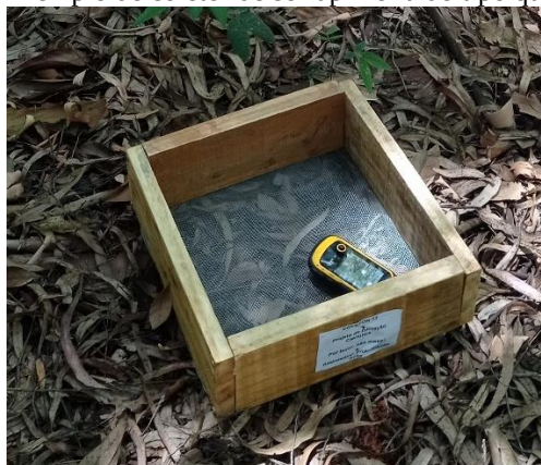
Figura 1 - Exemplo de coletor de serrapilheira do tipo quadrangular.
