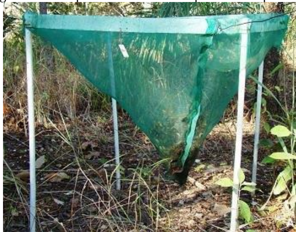
Figura 2 - Exemplo de coletor de serrapilheira do tipo cônico
