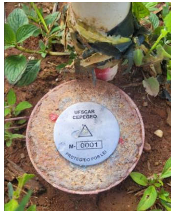
Figura 6: Vértice CP01 da Rede Cepegeo.
