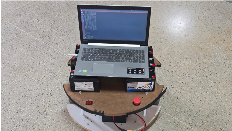
Figura 18 – Protótipo AMR operando com carga 2: 11,272 kg
