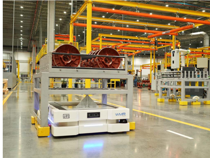
Figura 1 – Exemplo de AMR usado pela WEG do Brasil.
