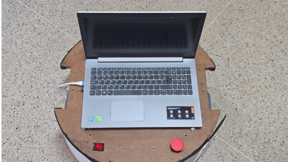
Figura 16 – Protótipo AMR em configuração de teste sem carga (vazio)
