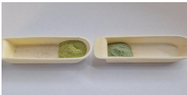
Figura 3.6: Pós precursores da perovskita dopada após seco e desaglomerado. Esquerda: dopado com óxido de irídio; Direita: dopado com óxido de rutênio.
