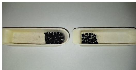
Figura 3.8: Pós da perovskita \text{LaNiO}_3 dopada após os tratamentos térmicos.
