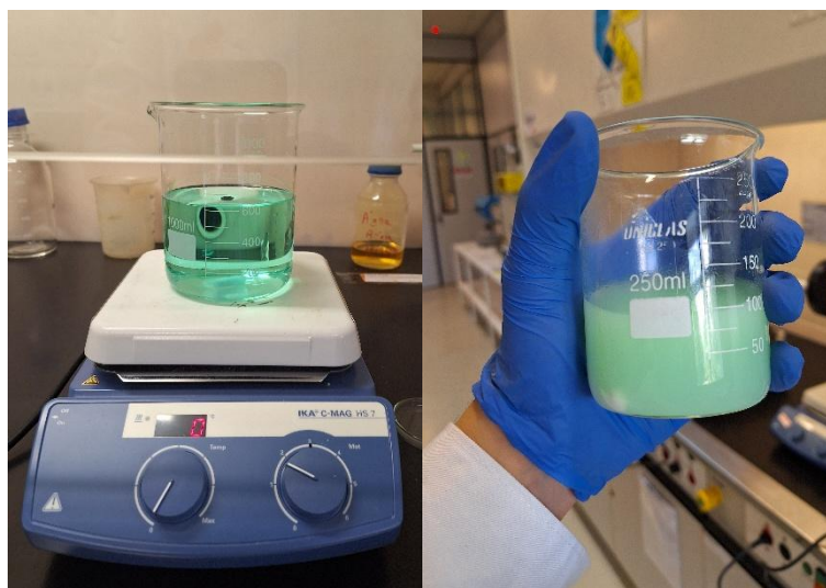
Figura 3.1: a) Solução formada com a mistura dos nitratos de lantânio e níquel dissolvidos em água. b) solução contendo os hidróxidos após precipitados.
