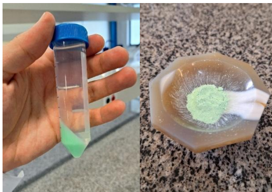
Figura 3.4: a) Pó precursor da perovskita \text{LaNiO}_3 após centrifugação. b) Pó precursor da perovskita após desaglomerado em almofariz.
