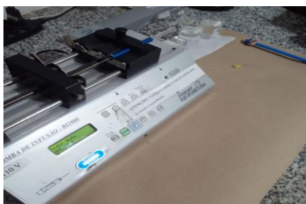
Figura 4 - Bomba de microinjeção.
