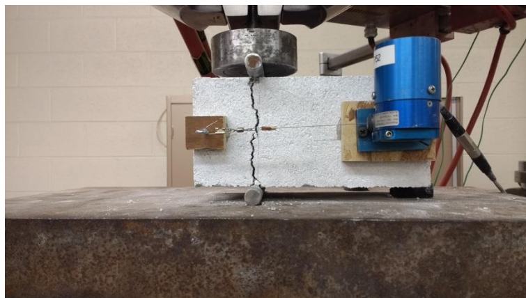
Figura 92 – Exemplo de Corpo de Prova de Tração Indireta - Após Ensaio
