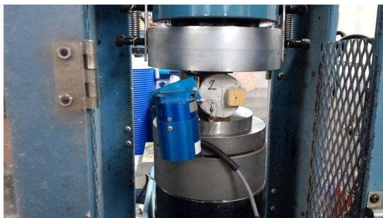
Figura 94 - Exemplo de Corpo de Prova de Compressão Diametral da Argamassa - Após o Ensaio
