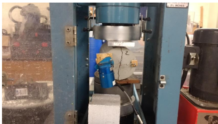
Figura 96- Exemplo de Corpo de Prova de Compressão Diametral do Graute - Após o Ensaio
