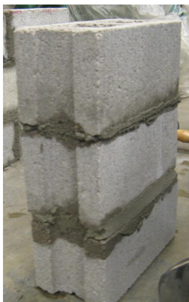
Figura 81 - Corpo de Prova - Ensaio de Cisalhamento da Junta e Bond Wrench
