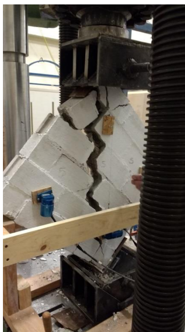
Figura 106 - Compressão Diagonal - Após a Ruptura
