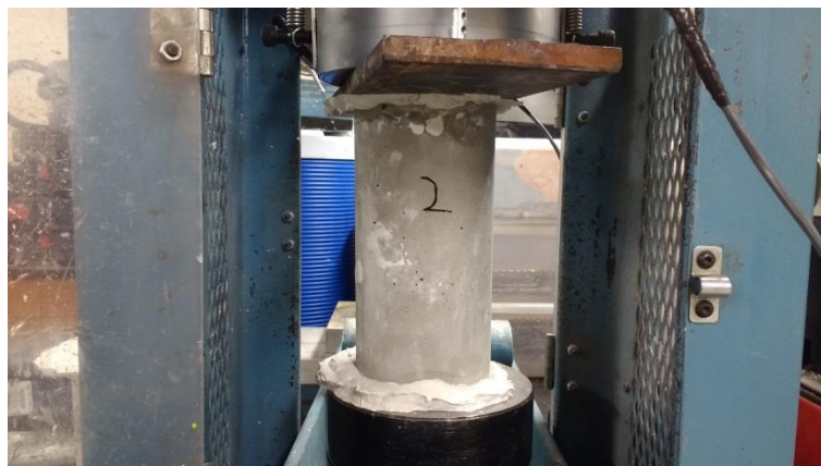
Figura 101 - Ruptura do Corpo de Prova
