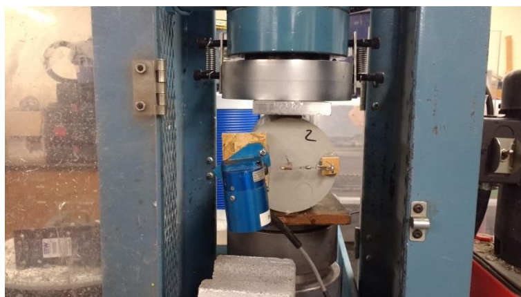
Figura 96- Exemplo de Corpo de Prova de Compressão Diametral do Graute - Após o Ensaio
