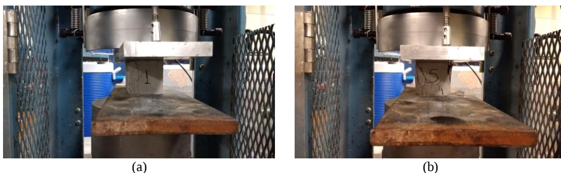
Figura 99 - Ruptura da Argamassa
