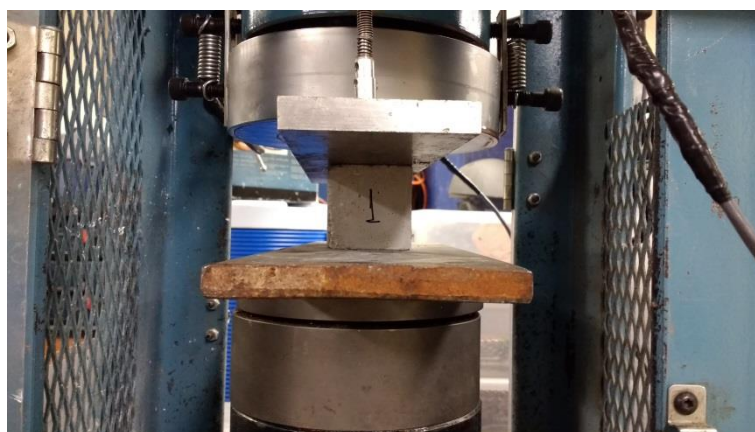
Figura 99 - Ruptura da Argamassa
