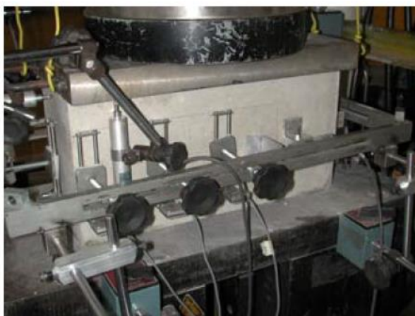
Figura 28 - Instrumentação para o ensaio de resistência à compressão dos blocos
