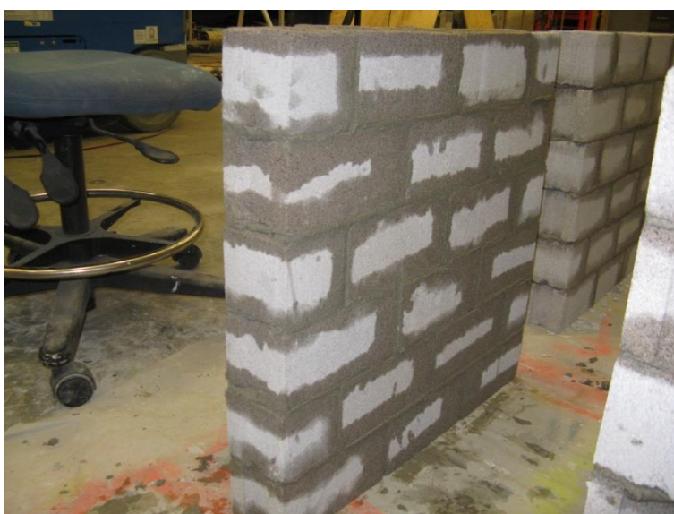
Figura 85 - Corpo de Prova - Compressão Diagonal
