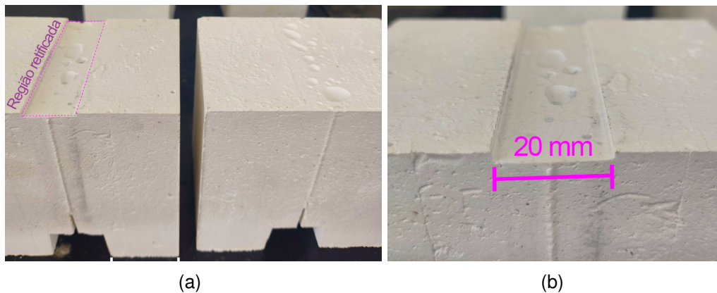
Figura 3.5: (a) CP com a base retificada à esquerda e outro sem à direita. (b) CP com a base retificada, vista mais próxima.
