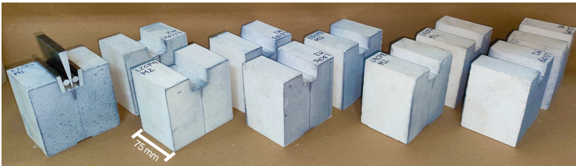
Figura 3.6: CPs produzidos retificados e com o aspecto mosqueado aplicado às duas faces opostas de interesse para a aplicação da CID.
