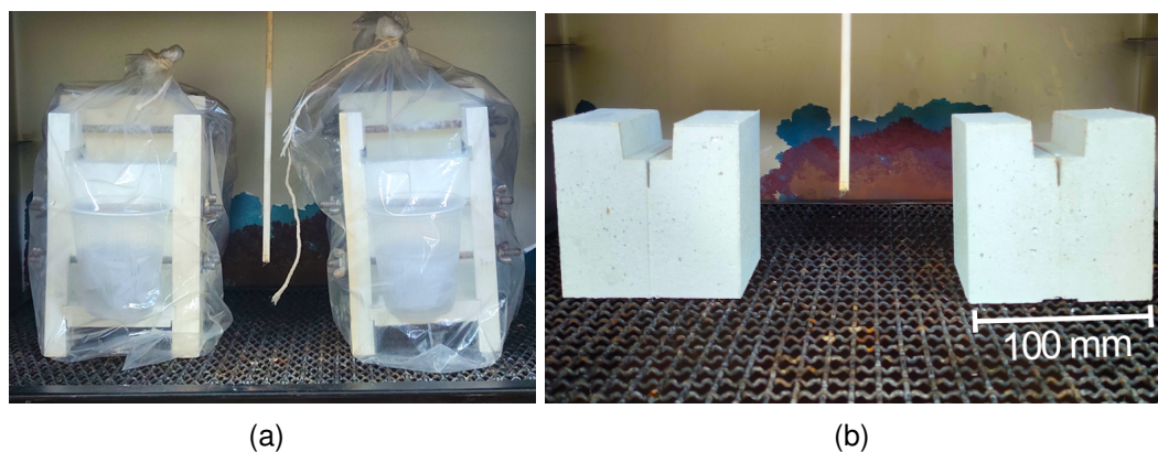
Figura 3.3: (a) CPs na estufa antes de serem submetidos ao processo de cura e (b) secagem.
