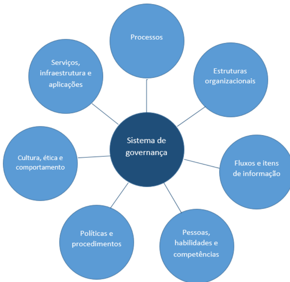
Figura 12 - Componentes COBIT de um sistema de governança de TI
