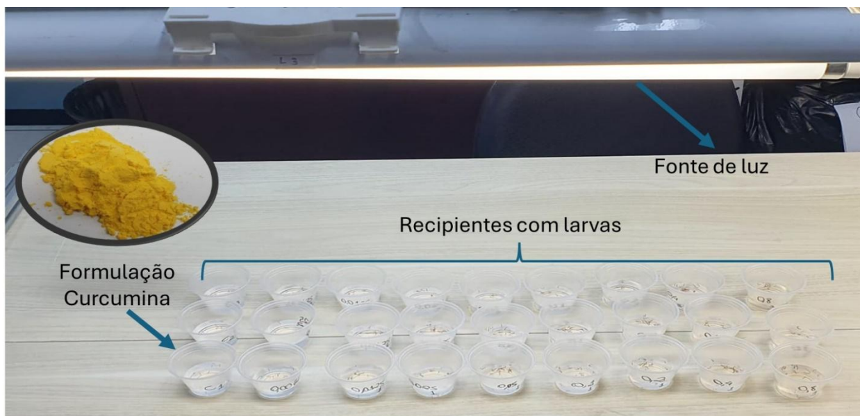
Figura 27. Representação dos ensaios de eficácia - recipientes com água destilada e lâmpadas fluorescentes de 18W, irradiância de 0,83 \text{ mW/cm}^2 , dose de luz: 35,85 \text{ J/cm}^2 .
