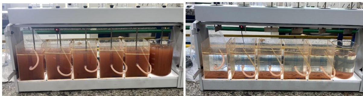
Figura 37 - Turbidez da água antes da adição do sulfato de alumínio (A) e após adição (B)
