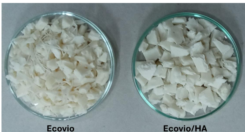
Figura 4.5 - Material utilizado para impressão 3D dos scaffolds (composições bem-sucedidas na análise de printabilidade).
