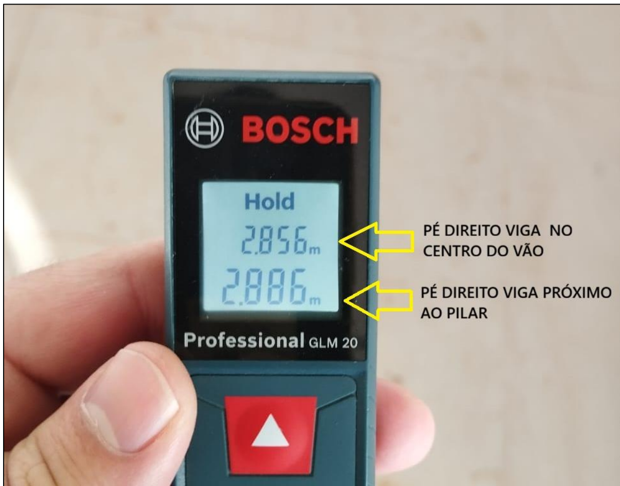
Figura 23 - Medição de deslocamento da viga
