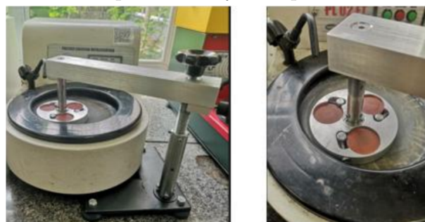
Figura 14 – Exemplo de retrofit em politriz metalográfica
