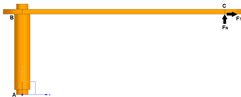
Figura 26 – Esquemático dos esforços no eixo
