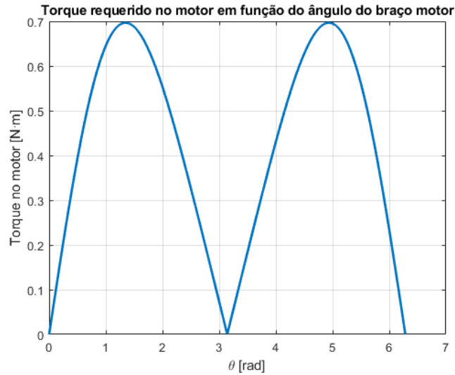
Figura 30 – Torque requerido no motor em função do ângulo do braço motor
