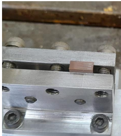
Figura 4 - Riscos feitos no inserto com o revestimento AlTiN/TiSiN.
