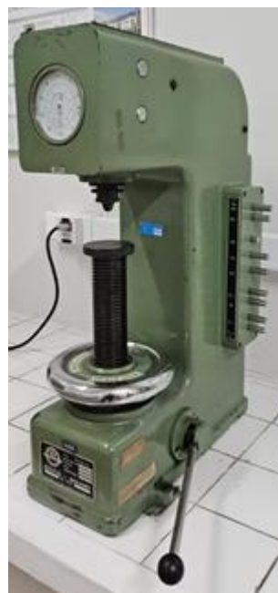
Figura 5 - Máquina de indentação Wolpert Testor HT1.
