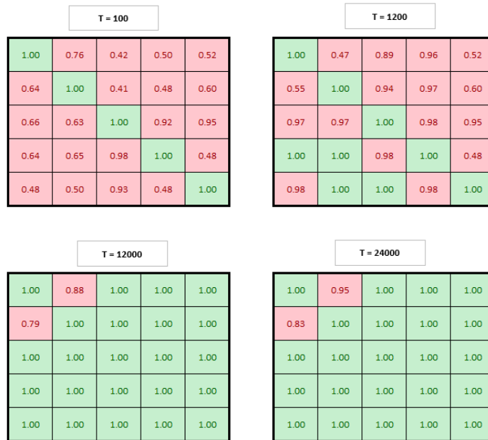
Figura B.5: Ilustração do grafo de conectividade por meio da proporção de acertos da conexão no cenário 2 para o método de estimação do grafo de conectividade por máxima verossimilhança sem regularização. Código de cor: Verde - 100% na proporção de acertos da conexão, Vermelho - caso contrário. Considerando a medida de precisão \epsilon = 0.2 .
