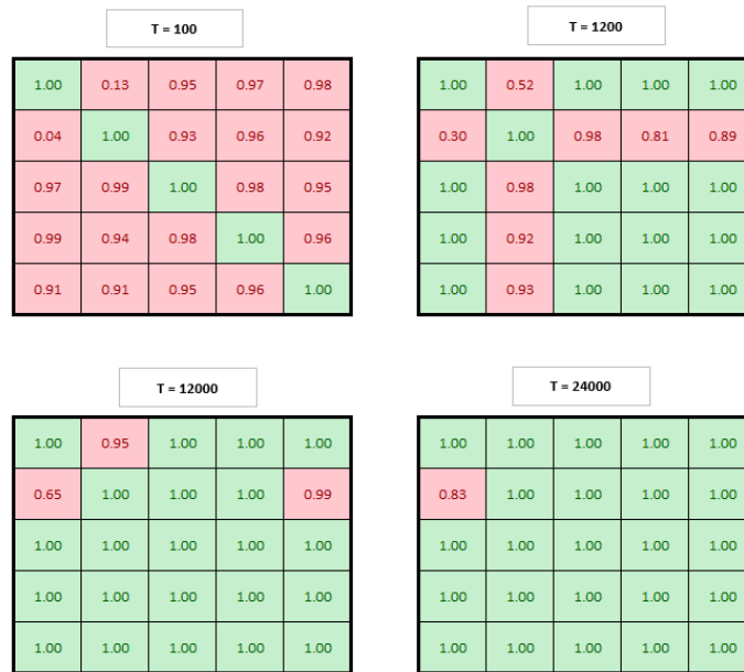
Figura B.11: Ilustração do grafo de conectividade por meio da proporção de acertos da conexão no cenário 4 para o método de estimação do grafo de conectividade por máxima verossimilhança sem regularização. Código de cor: Verde - 100% na proporção de acertos da conexão, Vermelho - caso contrário. Considerando a medida de precisão \epsilon = 0.2 .
