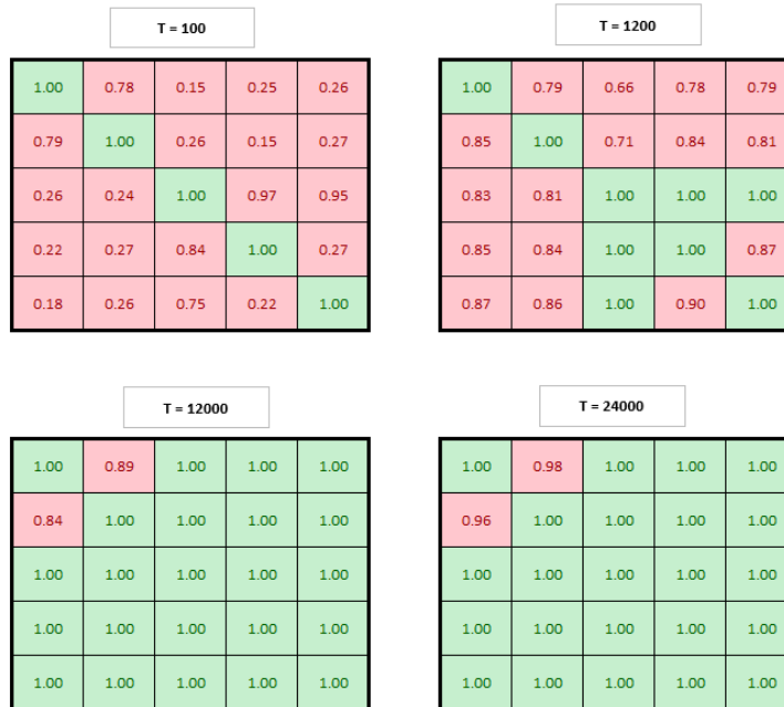
Figura B.3: Ilustração do grafo de conectividade por meio da proporção de acertos da conexão no cenário 1 para o método de do grafo de conectividade inspirado proposto. Código de cor: Verde - 100% na proporção de acertos da conexão, Vermelho - caso contrário. Considerando a medida de precisão \epsilon = 0.2 .
