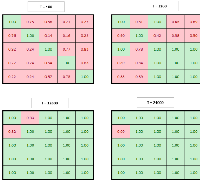
Figura B.6: Ilustração do grafo de conectividade por meio da proporção de acertos da conexão no cenário 2 para o método de do grafo de conectividade inspirado proposto. Código de cor: Verde - 100% na proporção de acertos da conexão, Vermelho - caso contrário. Considerando a medida de precisão \epsilon = 0.2 .
