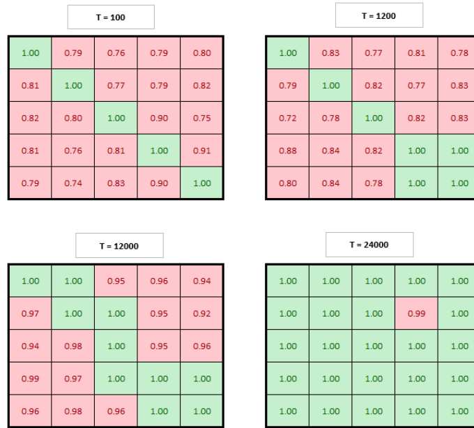
Figura B.18: Ilustração do grafo de conectividade por meio da proporção de acertos da conexão no cenário 6 para o método de do grafo de conectividade inspirado proposto. Código de cor: Verde - 100% na proporção de acertos da conexão, Vermelho - caso contrário. Considerando a medida de precisão \epsilon = 0.2 .
