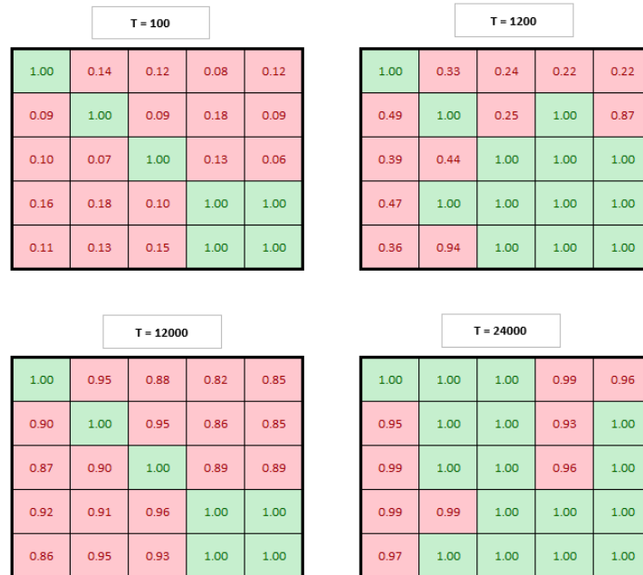
Figura B.17: Ilustração do grafo de conectividade por meio da proporção de acertos da conexão no cenário 6 para o método de estimação do grafo de conectividade por máxima verossimilhança sem regularização. Código de cor: Verde - 100% na proporção de acertos da conexão, Vermelho - caso contrário. Considerando a medida de precisão \epsilon = 0.2 .
