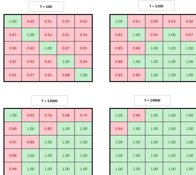
Figura B.13: Ilustração do grafo de conectividade por meio da proporção de acertos da conexão no cenário 5 para o método de estimação do grafo de conectividade por máxima verossimilhança com regularização LASSO. Código de cor: Verde - 100% na proporção de acertos da conexão, Vermelho - caso contrário. Considerando a medida de precisão \epsilon = 0.2 .
