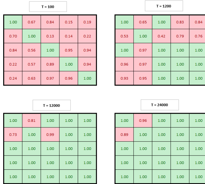
Figura B.4: Ilustração do grafo de conectividade por meio da proporção de acertos da conexão no cenário 2 para o método de estimação do grafo de conectividade por máxima verossimilhança com regularização LASSO. Código de cor: Verde - 100% na proporção de acertos da conexão, Vermelho - caso contrário. Considerando a medida de precisão \epsilon = 0.2 .
