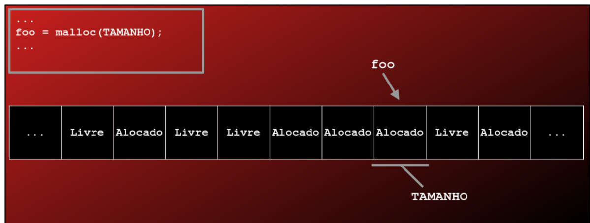
Figura 10 – Disposição hipotética de memória em heap após invocar malloc e o resultado ser armazenado na variável foo .
