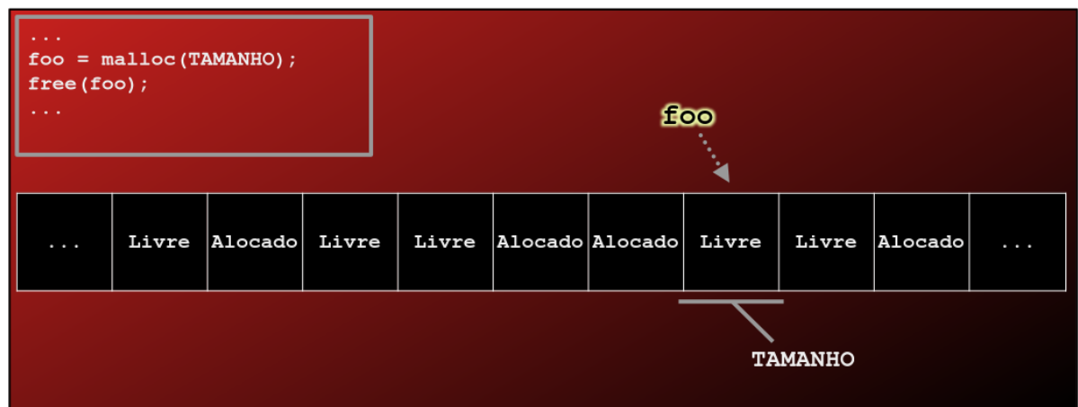
Figura 11 – Disposição hipotética de memória em heap após invocar free sobre o endereço armazenado na variável foo .
