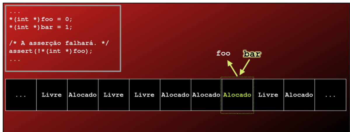
Figura 14 – Comprometimento da integridade dos dados obtidos através de foo , por indevida referência a uma região de memória por meio deste já liberada.
