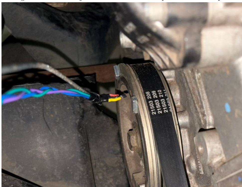
Figura 36 – Instalação do sensor e ímãs na polia do virabrequim
