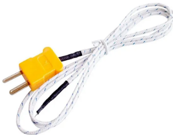
Figura 31 – Termopar tipo K utilizado com o multímetro MS-10
