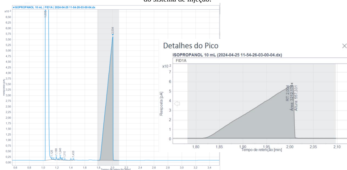
Figura 10 - Cromatograma de possível degradação de analito de interesse devido a altas temperaturas do sistema de injeção.
