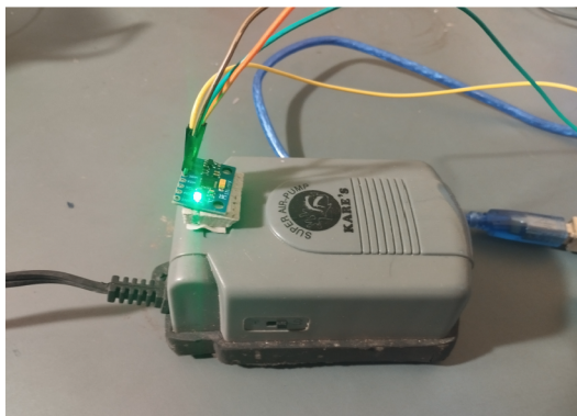
(a) Fixação sensor na bomba de ar
